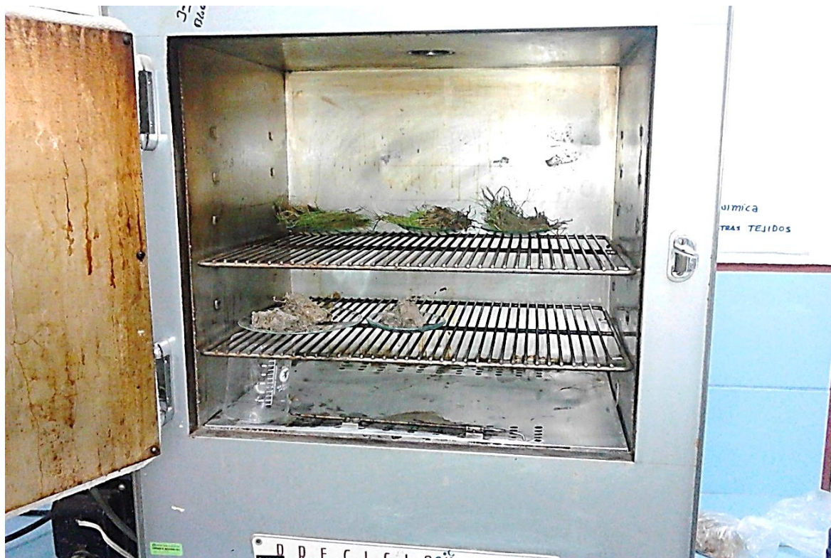
Figura 14. Secado de plantas en una estufa a 45 grados centígrados.
