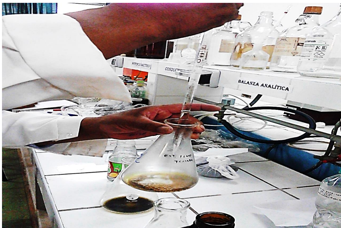
Figura 17. Introducción de Ácido sulfúrico a las muestras
