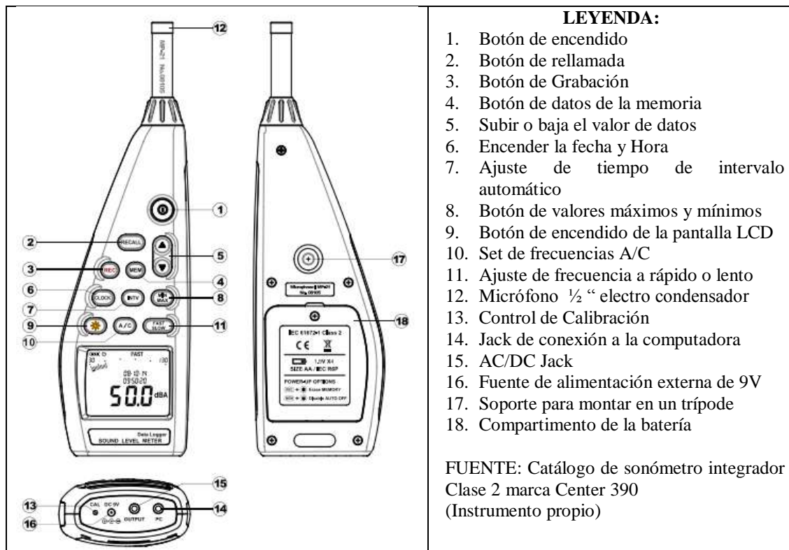
Figura 17: Componentes de un sonómetro integrador clase 2.
