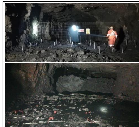
Figura N°3: Vista de la perforación tajo 08 y el carguío de Tajo 04 para el análisis de fragmentación
