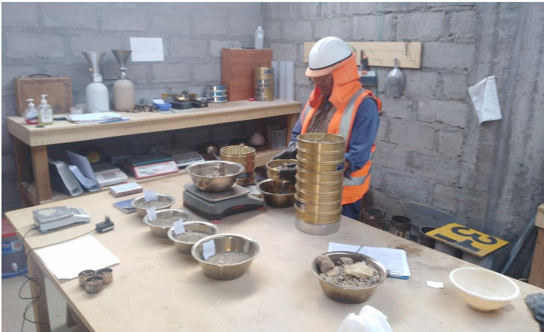
FOTO. N° 01: VISTA DE LA REALIZACIÓN DE ENSAYOS EN LABORATORIO, GRANULOMETRÍA DE SUELO DE FUNDACIÓN.
