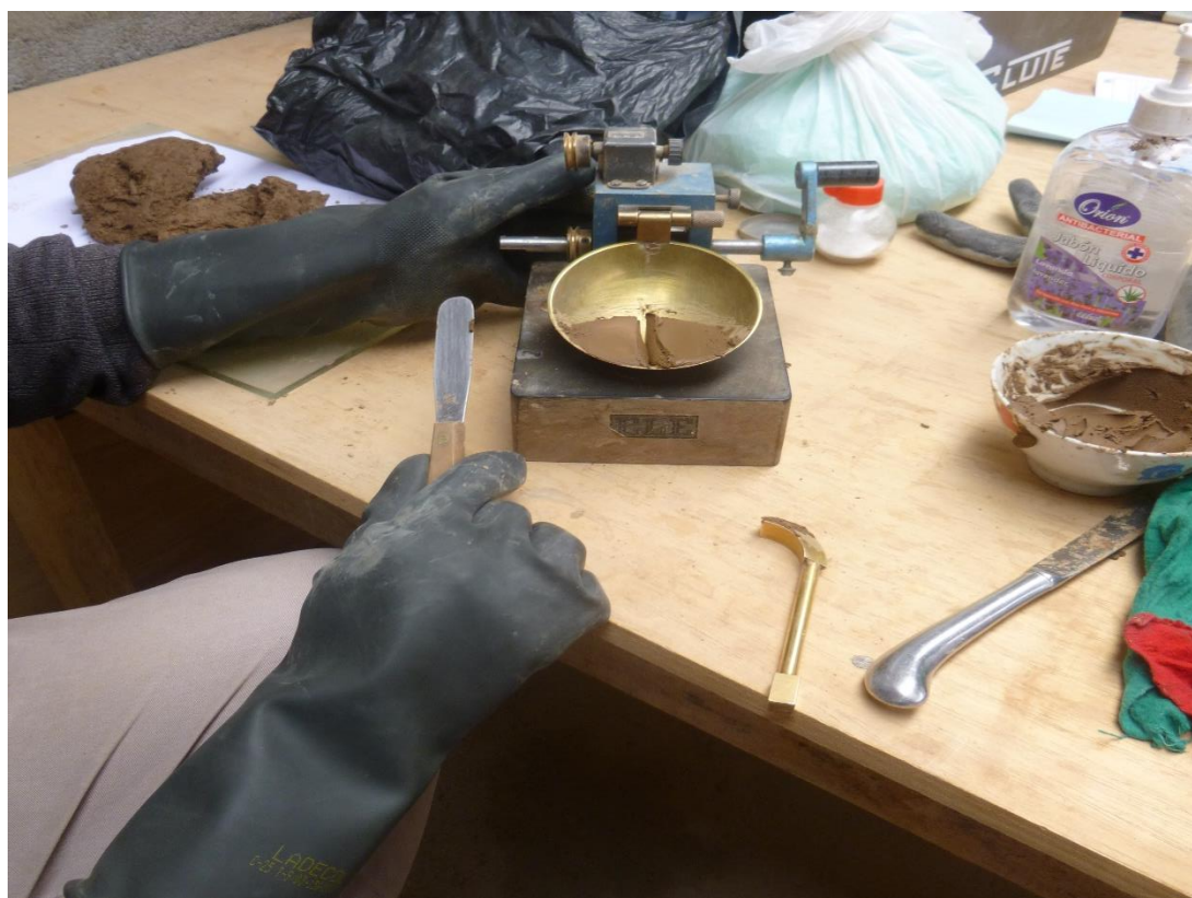
FOTO. N° 02: VISTA DE LA REALIZACIÓN DE ENSAYOS EN LABORATORIO, LÍMITE DE CONSISTENCIA DE SUELO DE FUNDACIÓN.
