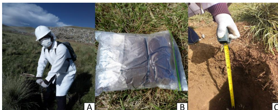
Figura 6: Toma de muestras para el aislamiento de hongos del botadero Cancharani de la ciudad de Puno. A) Punto de muestreo. B) Toma de muestra del botadero de Cancharani de la ciudad de Puno, para el aislamiento de hongos. C) Profundidad de muestreo de suelos.
