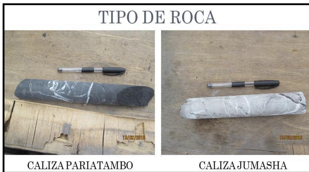
Figura 5: Testigo con perforación diamantina Fuente: Compañía minera San Valentín S.A.
