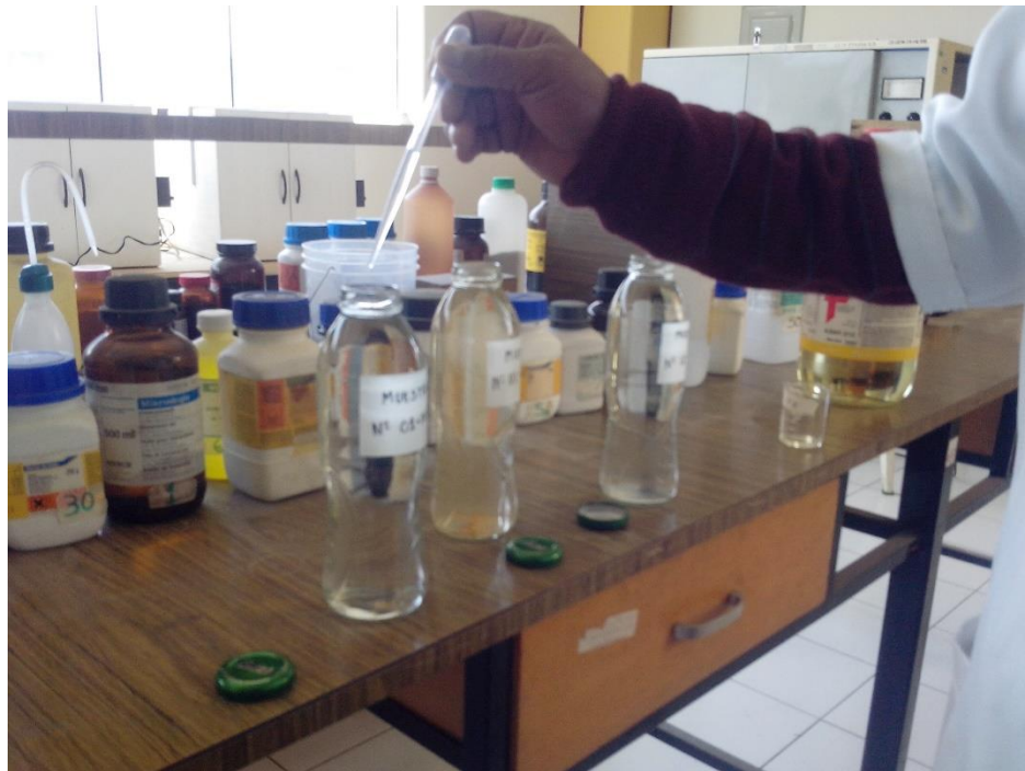
Fotografía 7. Adición De Acido, Para La Conservación De La Muestra
