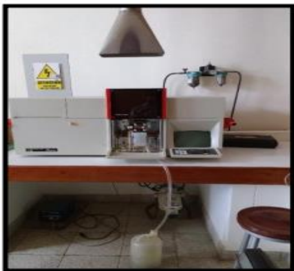
Figura N° 3 Adsorción atómica A. A S.
