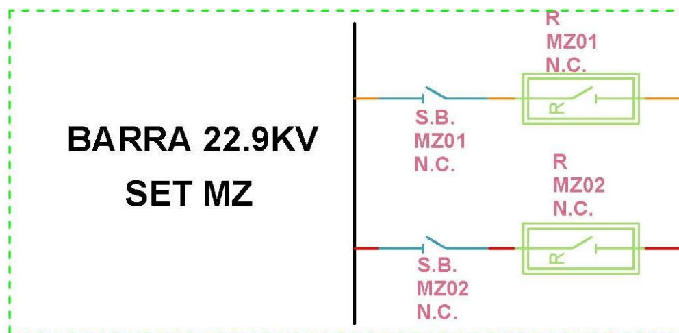
Figura 4. 2. Barra de alimentación en 22.9 KV
