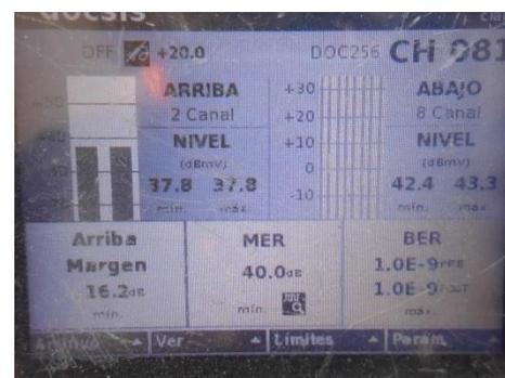
Por la tanto, tenemos en la imagen un nivel de MER de 40.7 dB BER PRE 1.0E-9 y un BER POST de 1.0E-9 Considerando que estos datos se muestran en los 8 canales del forward y en 2 canales del upstream.
