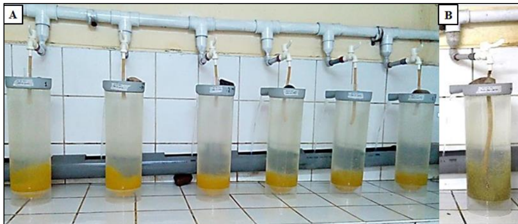
Figura 14. A) Incubación de ovas en vasos tipo Mac Donald con flujo de agua constante, B) Ovas incubadas a los 7 días de incubación. Laboratorio de Productos Hidrobiológicos de Agua Dulce - Puno, 06 de marzo del 2018.
