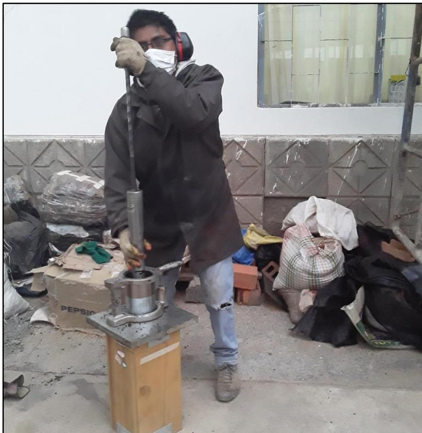
Figura 19 Molde, Martillo y Pedestal de Compactación Usados para la Mezcla y Compactación de las Probetas de Concreto Asfáltico.
