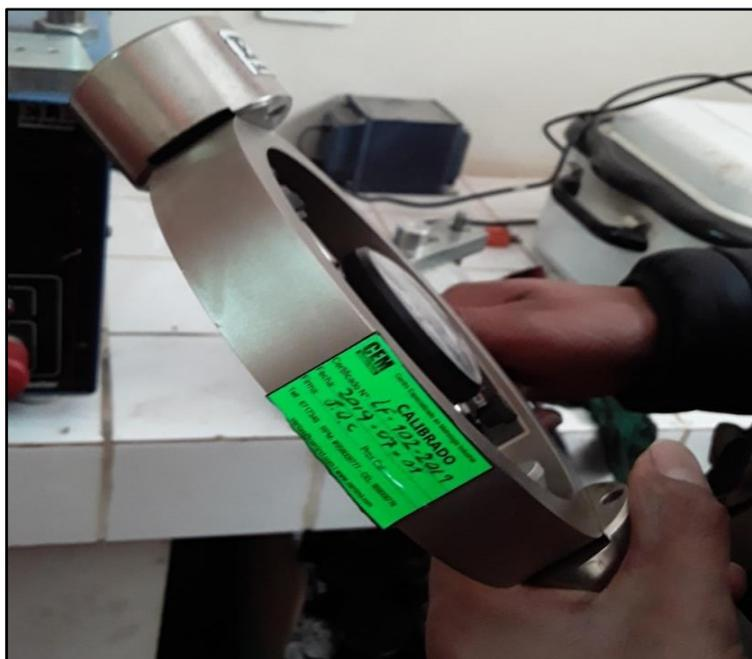
Figura 20 Anillo de Carga con su Dial que Facilita la Medición de la Estabilidad
