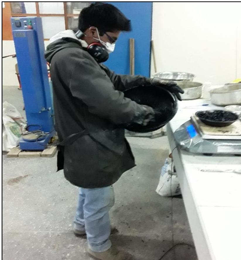
Figura 25 Pesado del Concreto Asfáltico Suelto
