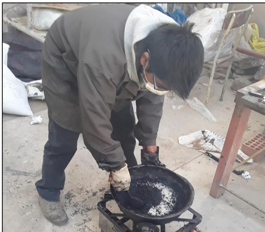
Figura 33 Incorporación del Tereftalato de Polietileno en el Concreto Asfáltico Mediante el Método Seco
