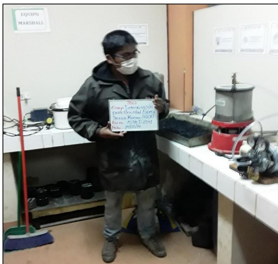
Figura 21 Equipos Usados en la Ejecución del Ensayo de Gravedad Específica Teórica Máxima
