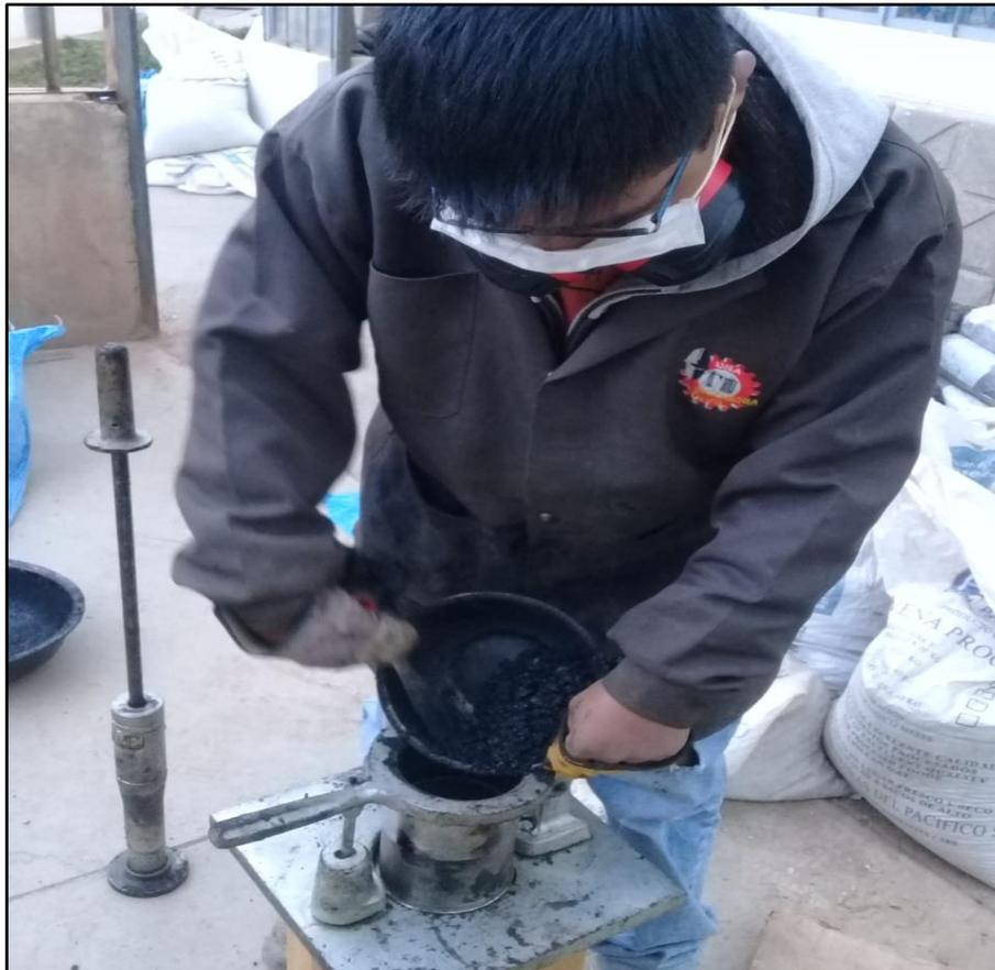
Figura 26 Vaciado del Concreto Asfáltico Suelto
