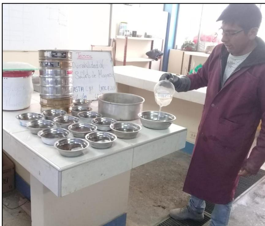
Figura 22 Sumersión de los Agregados Gruesos Previamente Tamizados, en la Solución de Sulfato de Magnesio como parte de la Ejecución del Ensayo de Durabilidad al Sulfato De Magnesio
