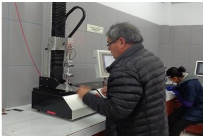
Figura 12. Determinación de la resistencia a la tracción y porcentaje de elongación.
