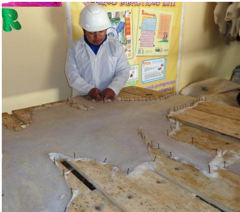
Foto 6. Proceso Post- Curtido: estirado y claveteado de cueros curtidos. Curtiembre Hatun Alpaca E.I.R.L.
