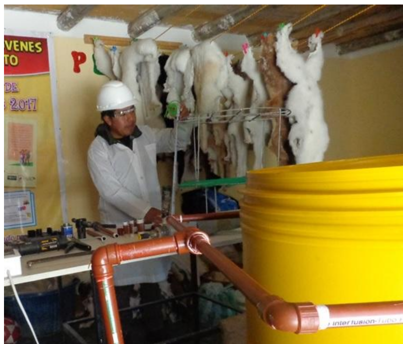
Foto 1. Dimensionamiento del reactor: toma de medidas del sistema de soportes de ambos niveles (superior e inferior) del reactor. Curtiembre Hatun Alpaca E.I.R.L.
