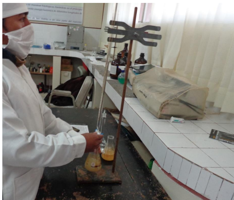
Foto 10. Titulación de yodo liberado: determinación del porcentaje de cromo. Laboratorio de Bioquímica de la Facultad de Medicina Veterinaria y Zootecnia de la Universidad Nacional del Altiplano Puno.
