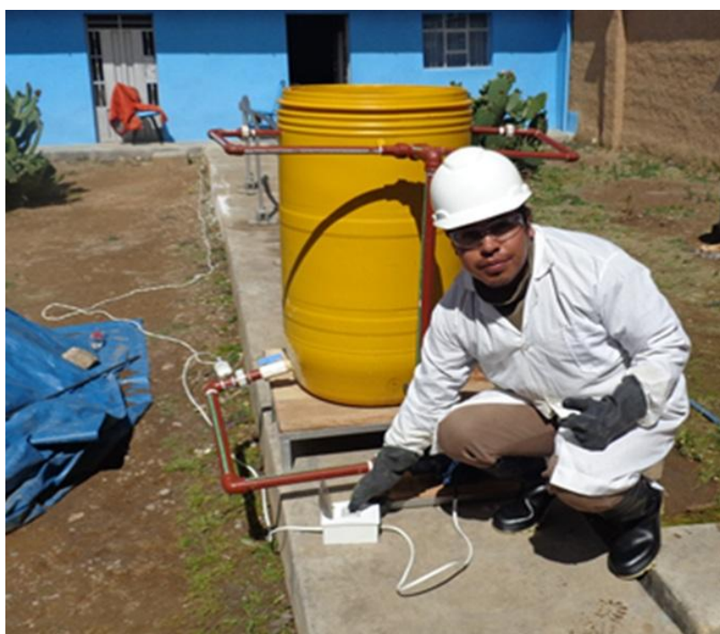
Foto 4. Inicio de operación del reactor: Arranque del reactor. Curtiembre Hatun Alpaca E.I.R.L.
