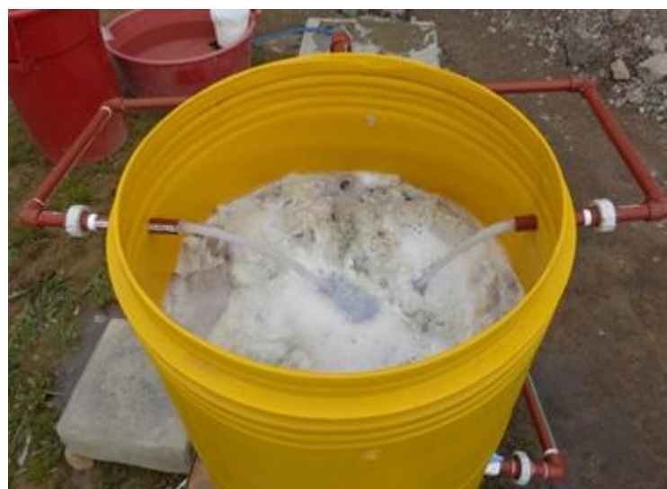
Figura 11. Pieles durante el proceso de neutralizado.
