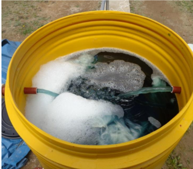
Foto 5. Proceso de curtido dentro del reactor: recirculación del baño de curtido. Curtiembre Hatun Alpaca E.I.R.L.
