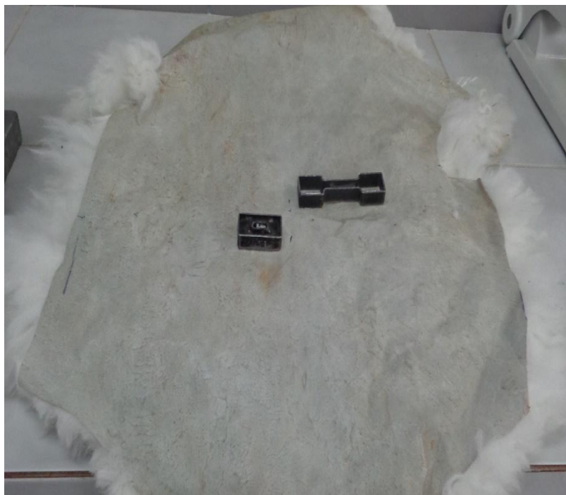
Foto 11. Toma de muestras para análisis físicos: ubicación de las muestras para los ensayos físicos. Laboratorio del Centro de Tecnología e Innovación Productiva Cuero Cochabamba – Bolivia.
