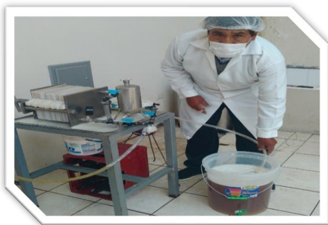
FOTO N° 7 Filtrado de la cerveza FUENTE: Equipos de planta piloto INGENIERIA QUIMICA
