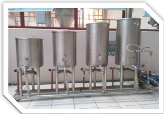
FOTO N° 1 EQUIPO DE MACERACION Y COCCION. FUENTE: Equipos de la Planta Piloto de INGENIERIA QUIMICA
