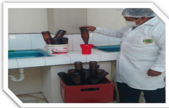
FOTO N° 6 Desinfección de botella FUENTE: Equipos de Planta Piloto de INGENIERIA QUIMICA
