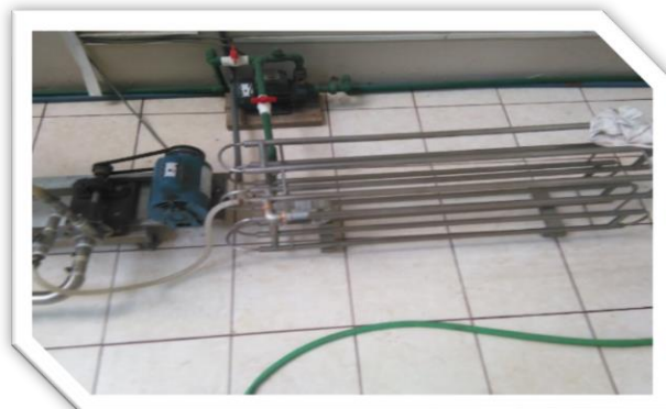
FOTO N° 2 EQUIPO DE INTERCAMBIADOR DE CALOR. FUENTE: Equipos de la Planta Piloto de INGENIERIA QUIMICA
