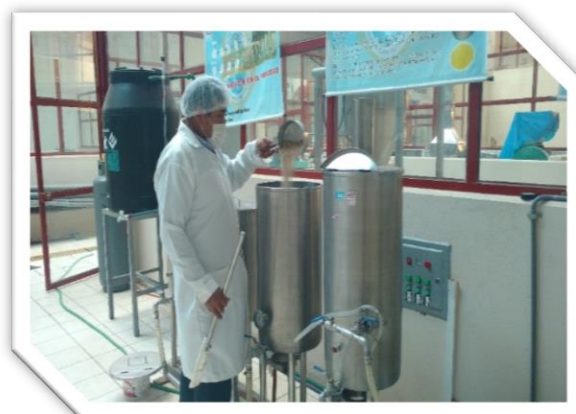
FOTO N° 4 Sistema de maceración de malta FUENTE: Equipos de la Planta Piloto de INGENIERIA QUIMICA
