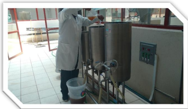
FOTO N° 5 Sistema de homogenización FUENTE: Equipos de Planta Piloto de INGENIERIA QUIMICA
