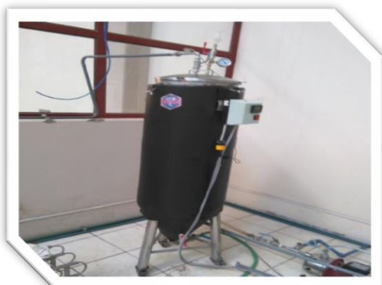
FOTO N° 3 Equipo de fermentación FUENTE: Equipos de la Planta Piloto de INGENIERIA QUIMICA
