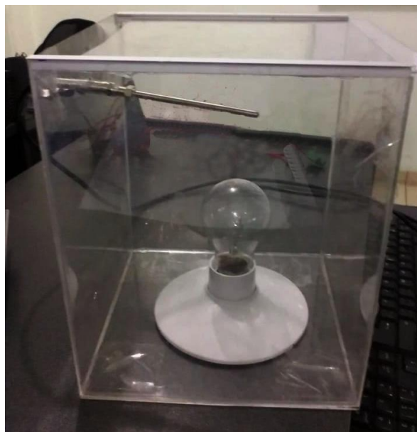
Figura 13: Instalación del sensor de temperatura RTD Pt100
