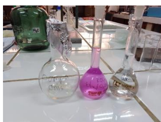
Fotografía N°23: Muestra de aceite esencial y reactivos para la determinación del índice de saponificación
