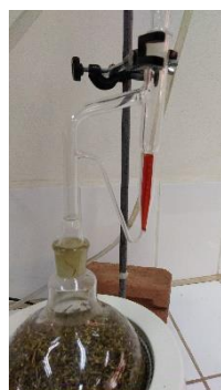
Fotografía N°5: Extacción del aceite esencial- Hidrodestilación con trampa de Clevenger
