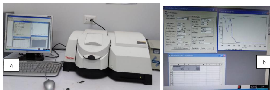
Fotografía N°27: Espectrometro Infrarrojo con Transformadas de Fourier FTIR–ATR. Dispositivo ATR (Reflectancia total atenuada) del FTIR
