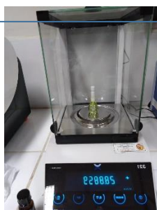
Fotografía N°17: Densidad-Pesando el picnómetro con el aceite esencial
