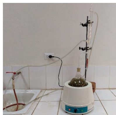
Fotografía N°4: Extracción del aceite esencial- Hidrodestilación con trampa de
