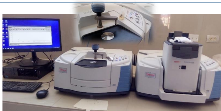
Fotografía N°27: Espectrometro Infrarrojo con Transformadas de Fourier FTIR–ATR. Dispositivo ATR (Reflectancia total atenuada) del FTIR
