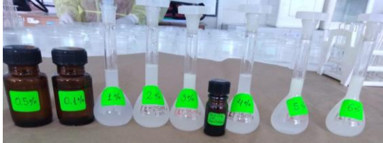
Fotografía N°28: Preparación de las concentraciones del aceite esencial
