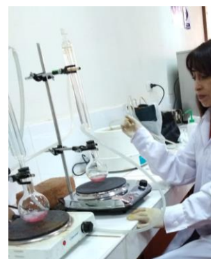
Fotografía N°24: Reflujo del aceite esencial con solución etanólica de
