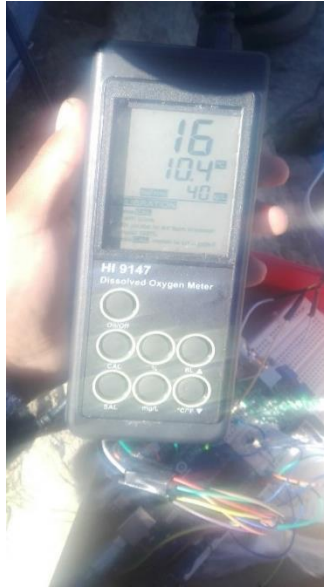
Figura 54: Validación de temperatura con dispositivo HI 9147.
