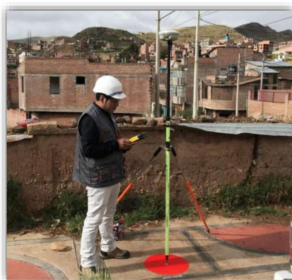
Figura N° 14: Se observa el registro del punto de control MPRI-FIC-07 en el GPS
