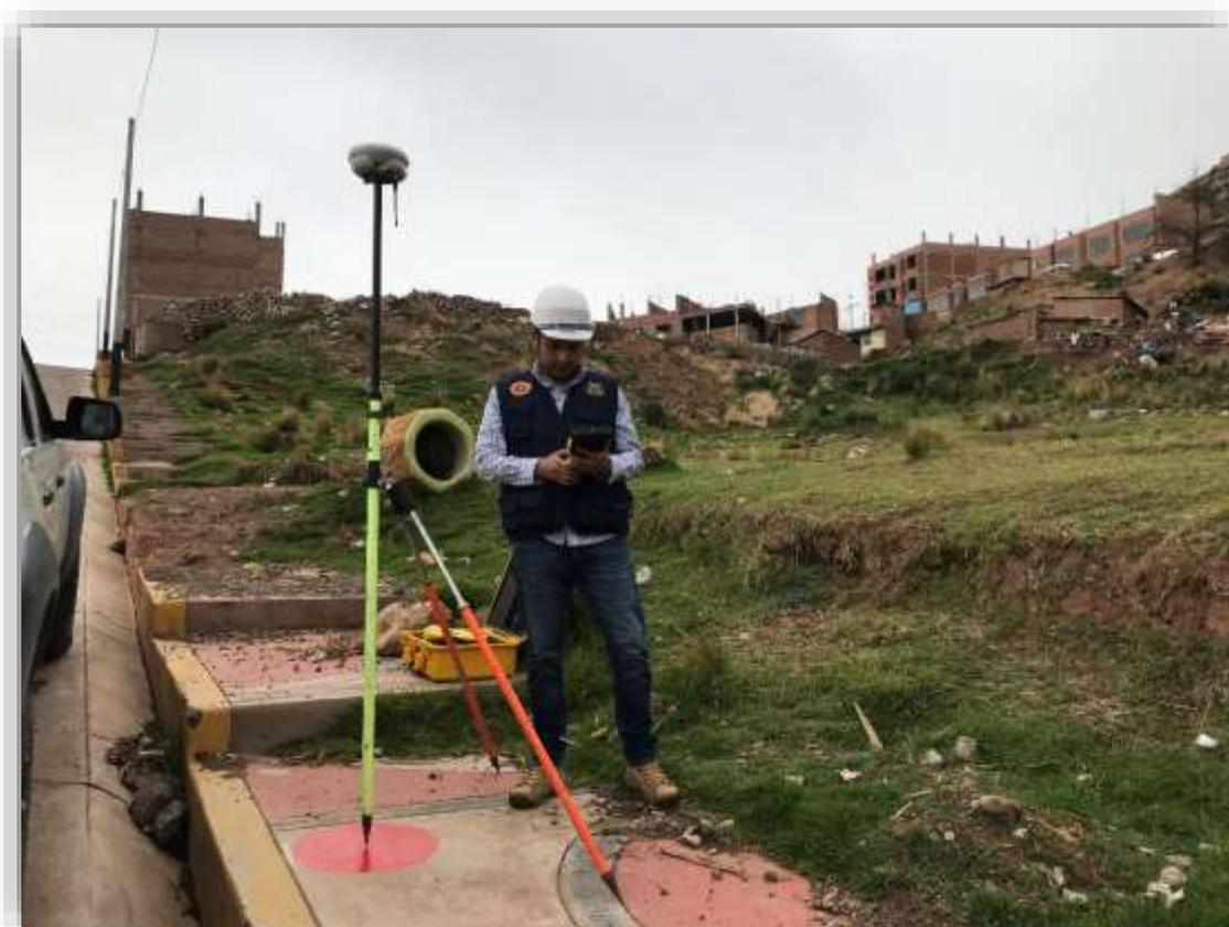
Figura N° 8: Se observa el registro del punto de control MPRI-FIC-04 en el GPS Diferencial modelo R8
