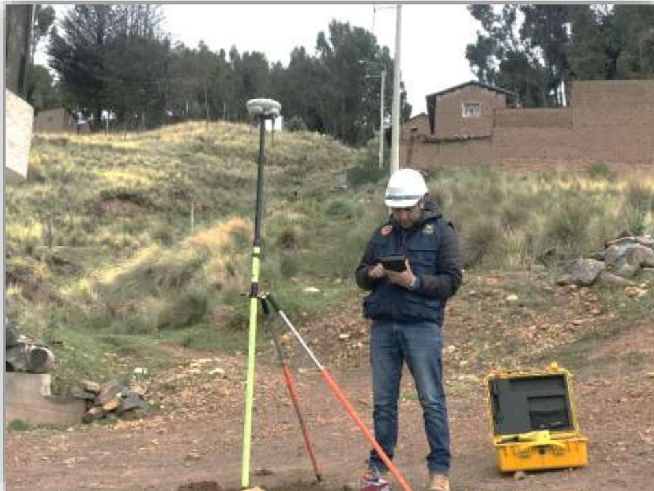
Figura N° 16: Se observa el registro del punto de control MPRI-FIC-08 en el GPS
