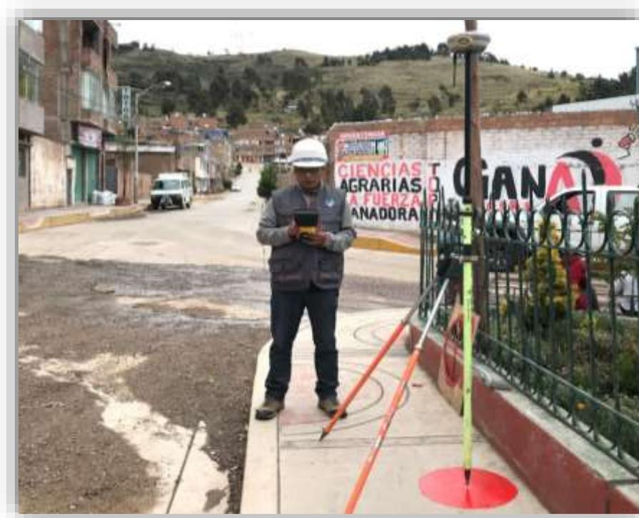
Figura N° 6: Se observa el registro del punto de control MPRI-FIC-03 en el GPS Diferencial modelo R8
