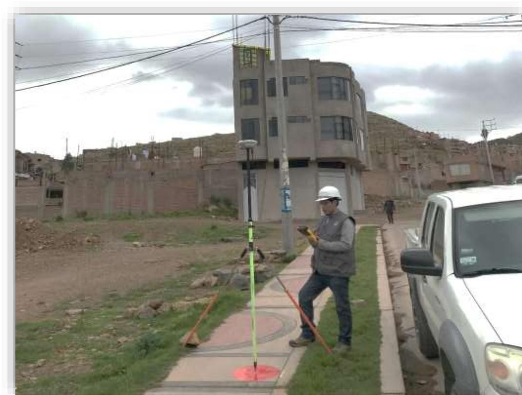
Figura N° 10: Se observa el registro del punto de control MPRI-FIC-05 en el GPS
