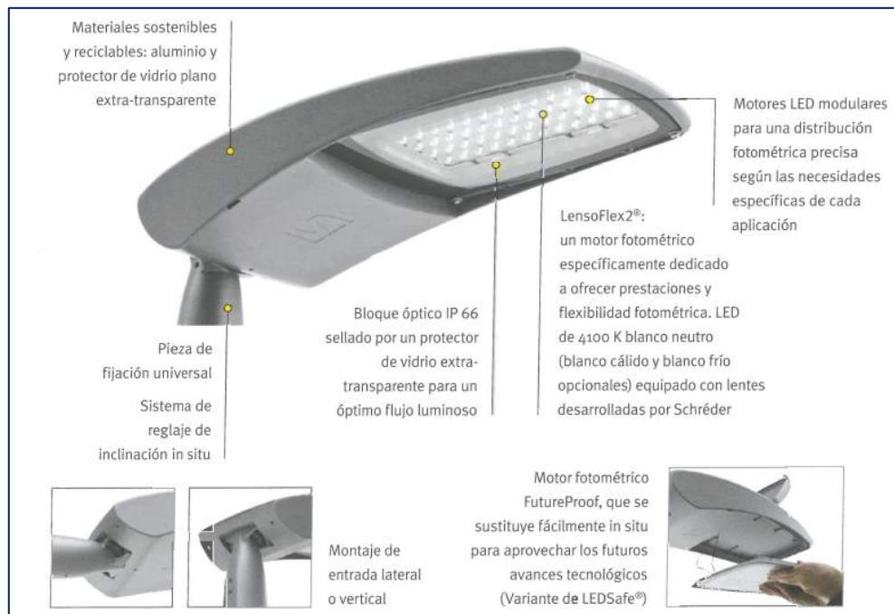
Figura 36: Partes de una luminaria LED (Vista lateral)
