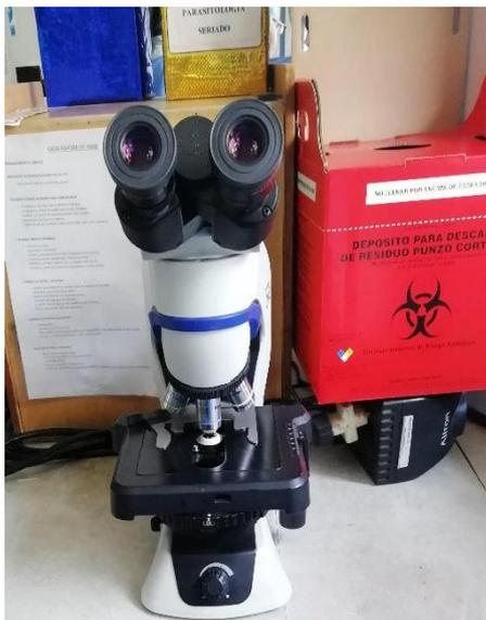
**Figura 25:** Microscopio binocular
