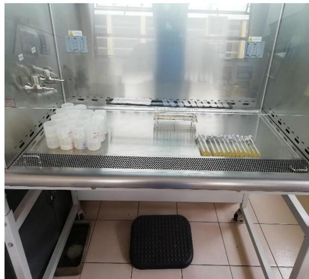
**Figura 22:** Cámara de bioseguridad
