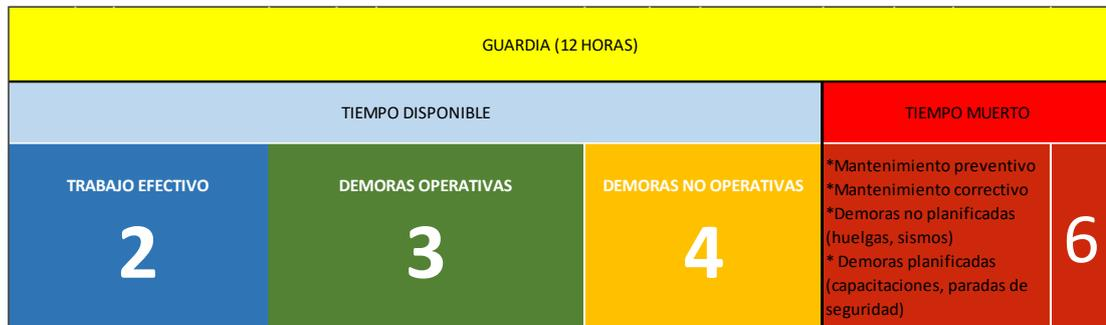
**Figura N° 34: Diagrama de tiempos en operaciones mineras.**
