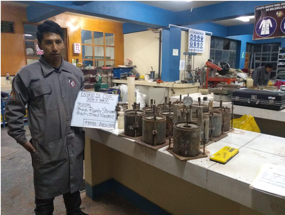
FOTO 15: PROCEDIMIENTO ENSAYO CBR
