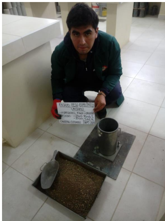
FOTO 24: PROCEDIMIENTO ENSAYO PESO ESPECIFICO UNITARIO DE AGREGADOS
