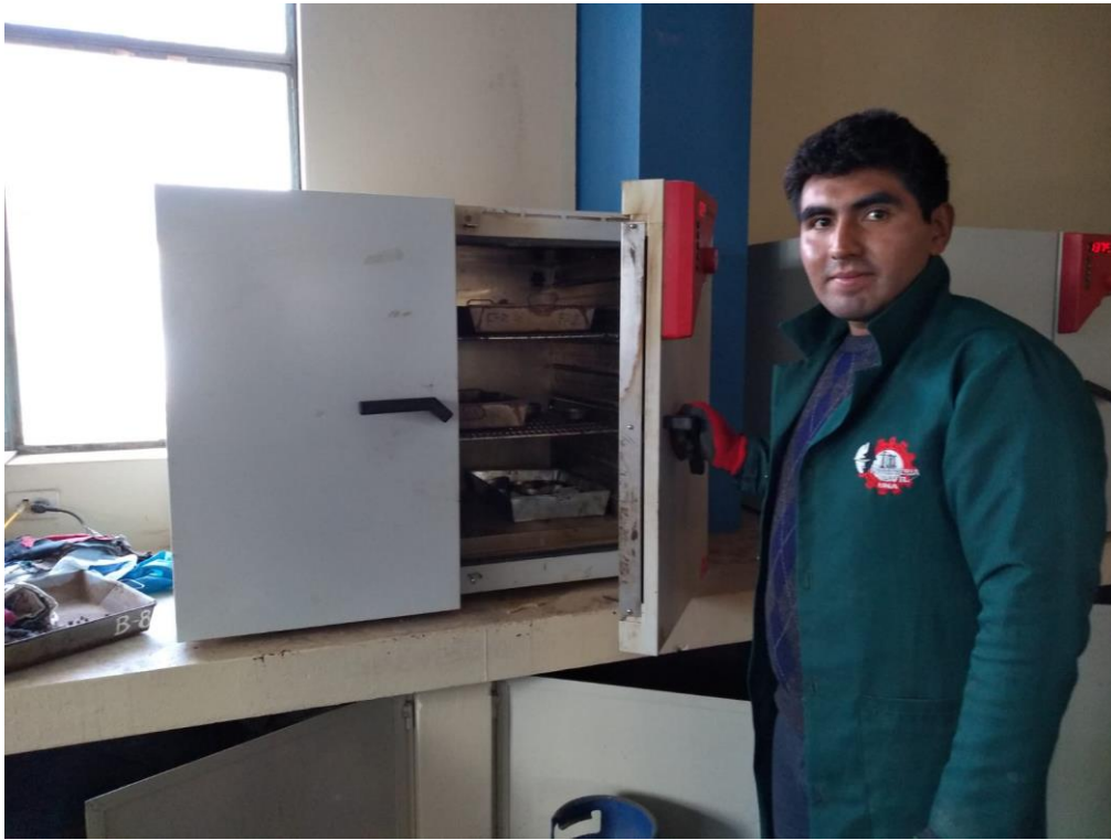
FOTO 05: PROCEDIMIENTO ENSAYO CONTENIDO DE HUMEDAD
