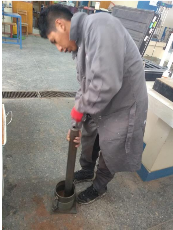
FOTO 12: PROCEDIMIENTO ENSAYO PROCTOR MODIFICADO
