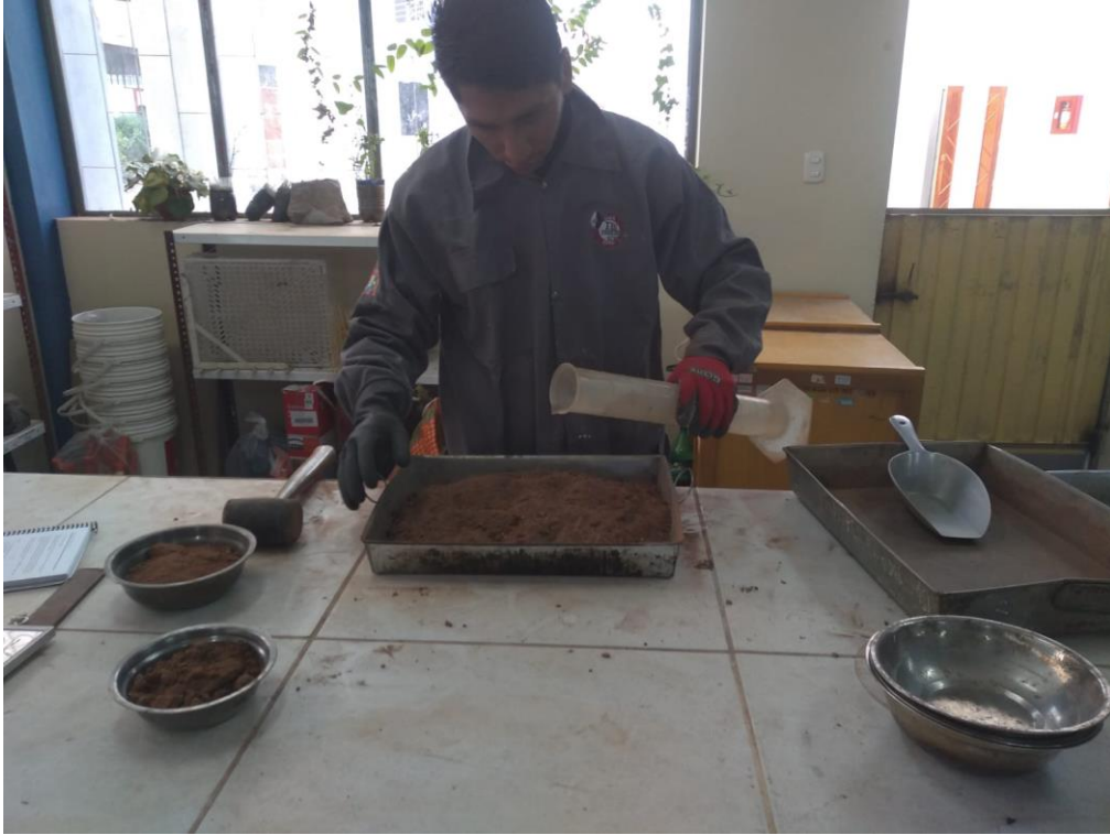
FOTO 11: PROCEDIMIENTO ENSAYO PROCTOR MODIFICADO
