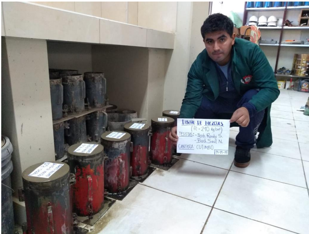
FOTO 26: PREPARACIÓN DE BRIQUETAS DE CONCRETO
