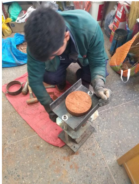
FOTO 14: PROCEDIMIENTO ENSAYO PROCTOR MODIFICADO
