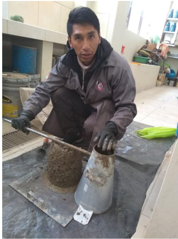
FOTO 25: PROCEDIMIENTO DE MEZCLA DE CONCRETO - SLUMP
