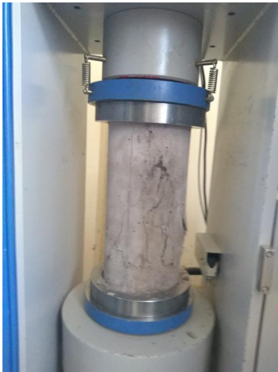
FOTO 28: ROTURA DE BRIQUETAS DE CONCRETO RESISTENCIA 210KG/CM2
