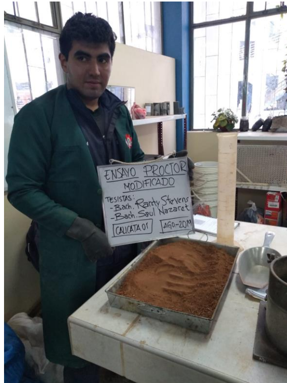
FOTO 13: PROCEDIMIENTO ENSAYO PROCTOR MODIFICADO
