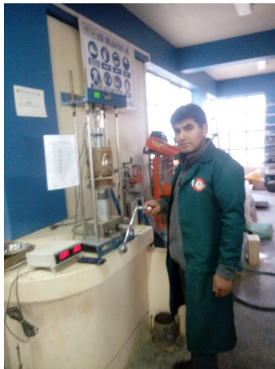
FOTO 16: PROCEDIMIENTO ENSAYO CBR
