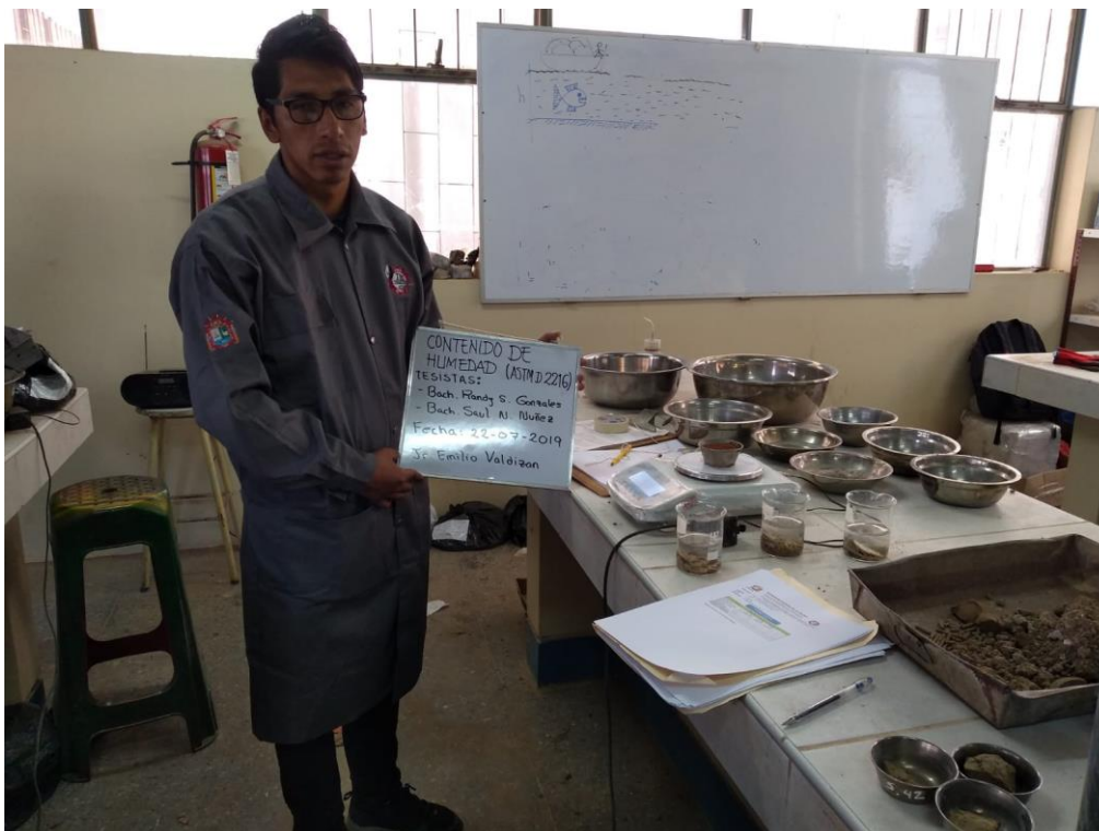
FOTO 04: PROCEDIMIENTO ENSAYO CONTENIDO DE HUMEDAD
