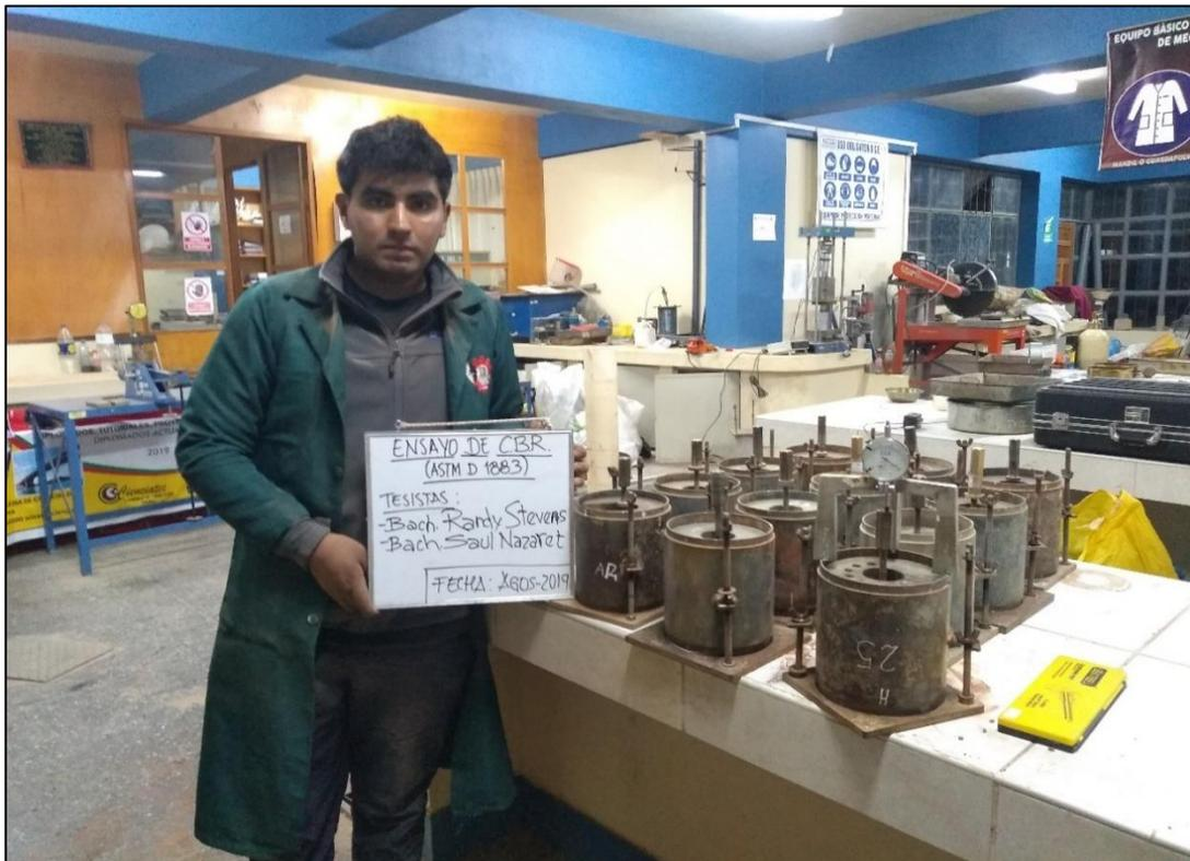
*Figura N° 28: Ensayo de CBR de suelos*
