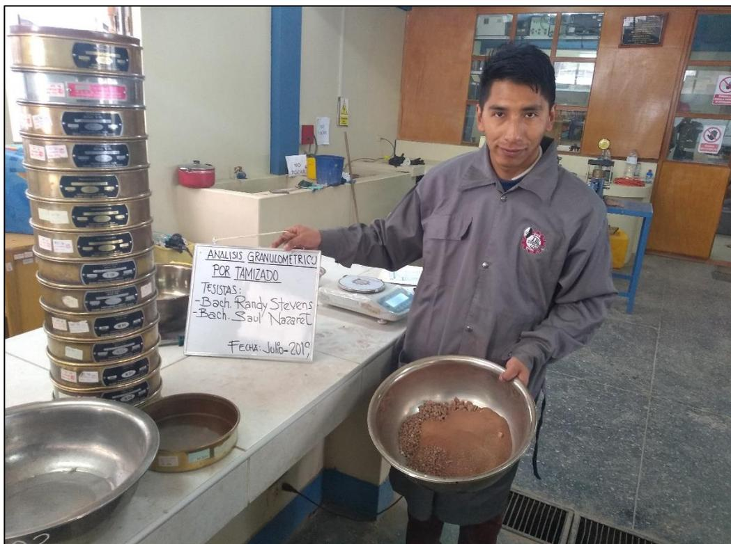
*Figura N° 24: Análisis Granulométrico por Tamizado*
