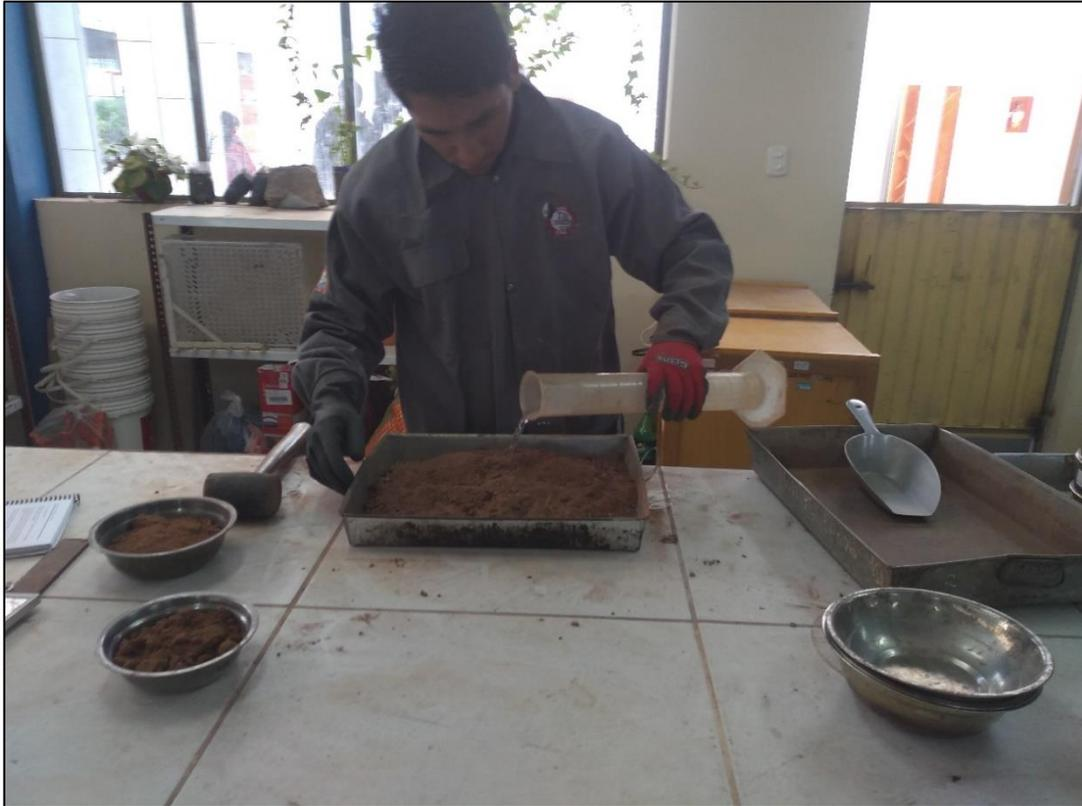
*Figura N° 27: Ensayo Proctor Modificado*
