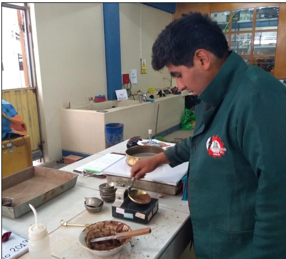
*Figura N° 26: Determinación del Límite Líquido de los Suelos*
