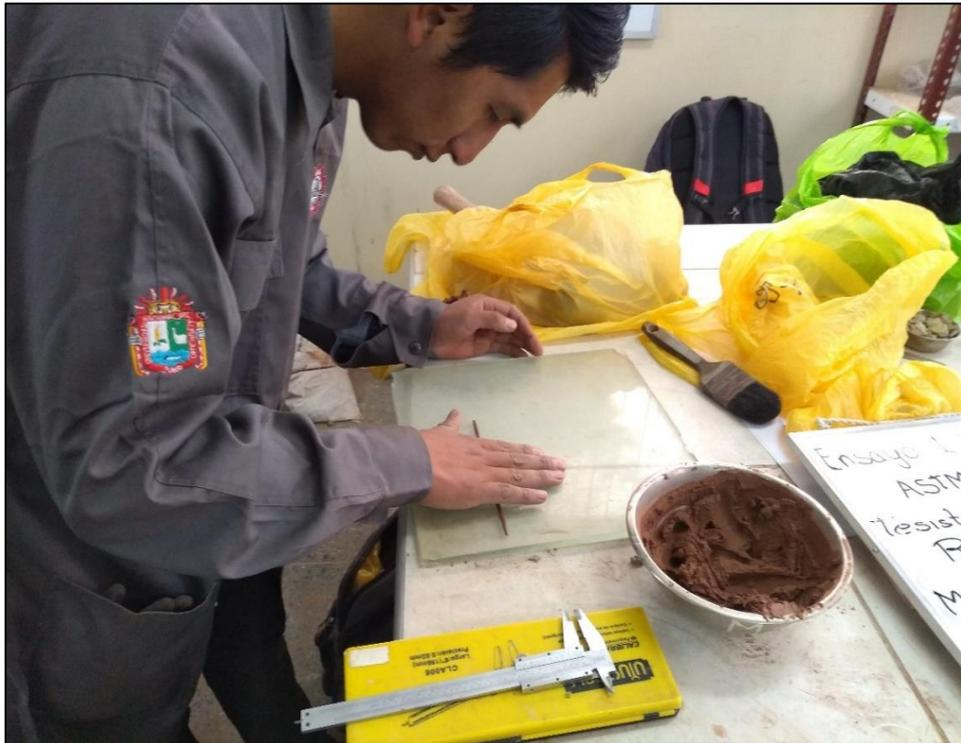
*Figura N° 25: Determinación del Límite Plástico*
