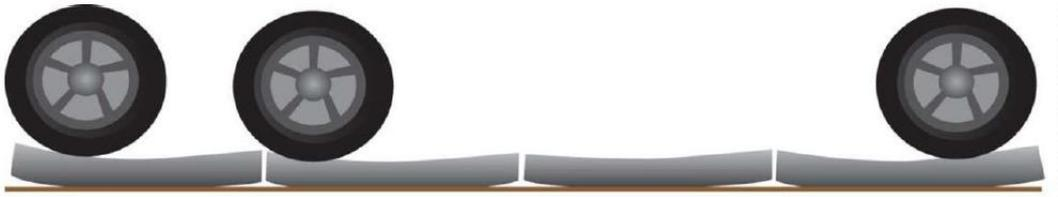
Figura N° 3: Distribución de Set De Ruedas en el Pavimento
