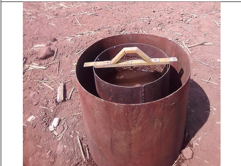
Prueba de infiltración por el método de cilindros infiltrómetros
