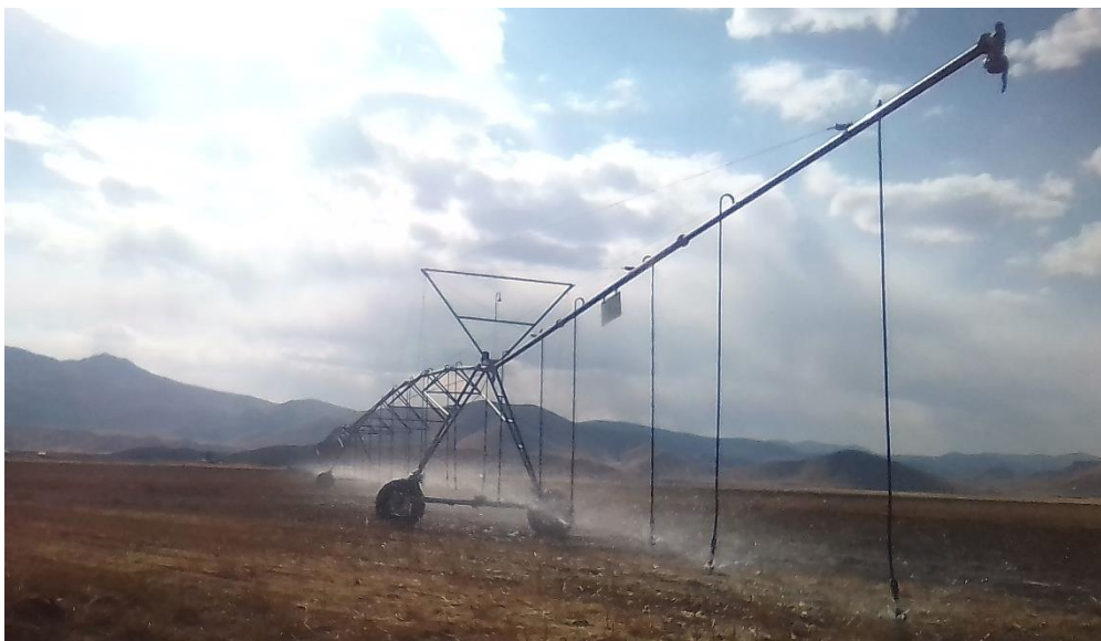
Figura 9: Sistema riego por pivote central en funcionamiento
