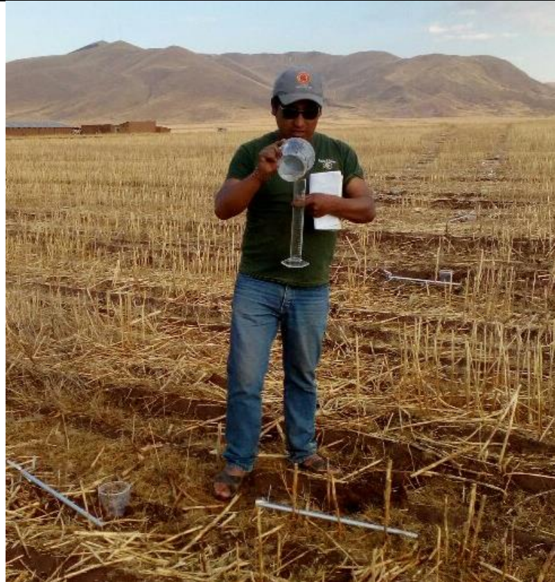
Prueba de pluviometría-colecta de lámina precipitada
