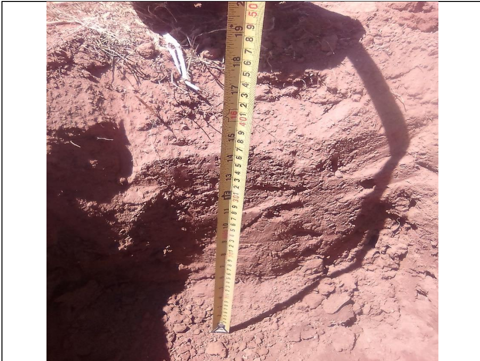
Calicatas de profundidad de 40cm para obtención de densidad aparente
