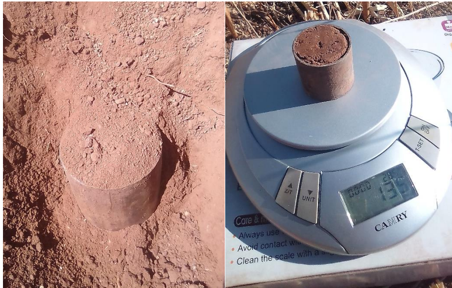
Figura 12: Obtención y pesaje la muestra en campo
