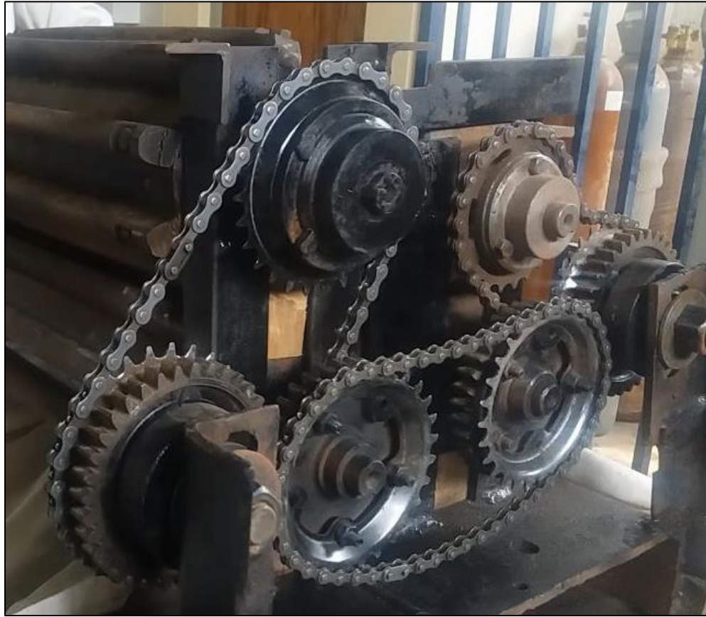
Figura N° 50: Ensamble del Sistema de Transmisión Compacto: Cadenas y Engranajes
