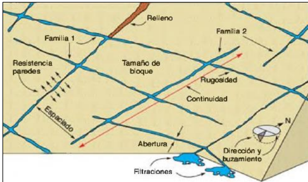
Figura 1. Representación esquemática de las propiedades geométricas de las discontinuidades (Hudson & Harrison, 2000)
