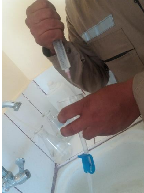
Figura 13 Lavado de las paredes del filtro EMCON con PBS.
