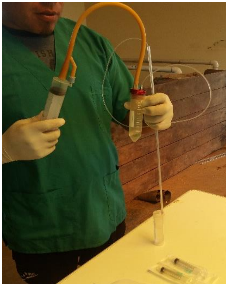
Figura 11 Bomba de vacío a una presión de 75 mm Hg.
