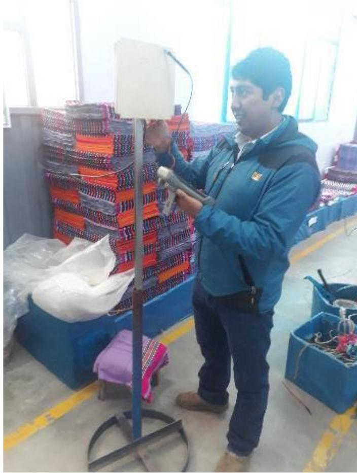
Calibración de antena RFID
