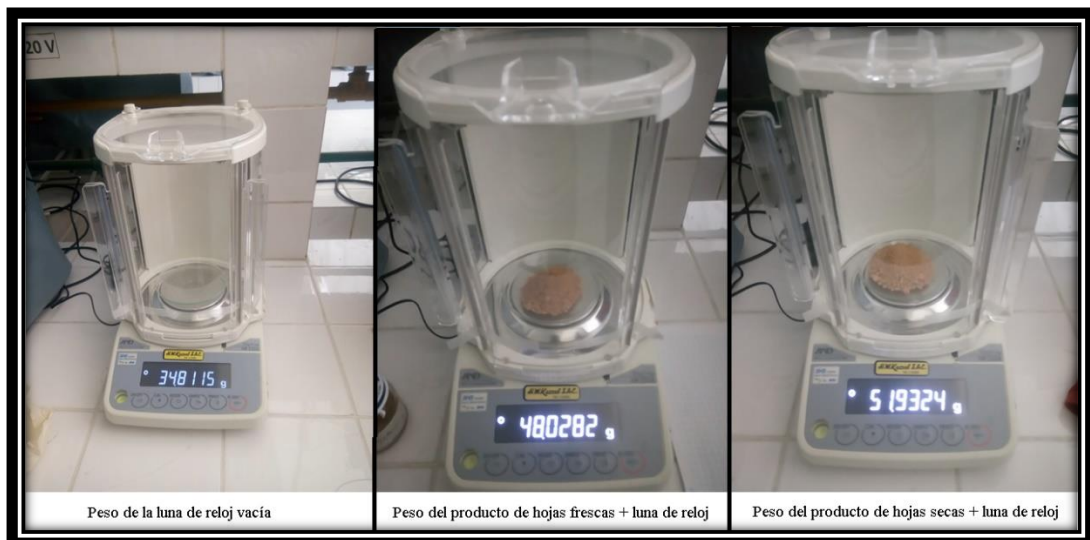
Figura C.14: Pesado de los productos en polvo de hojas frescas y secas utilizando una balanza analítica de marca H.W.K. Kessel, modelo HR- 25A.
