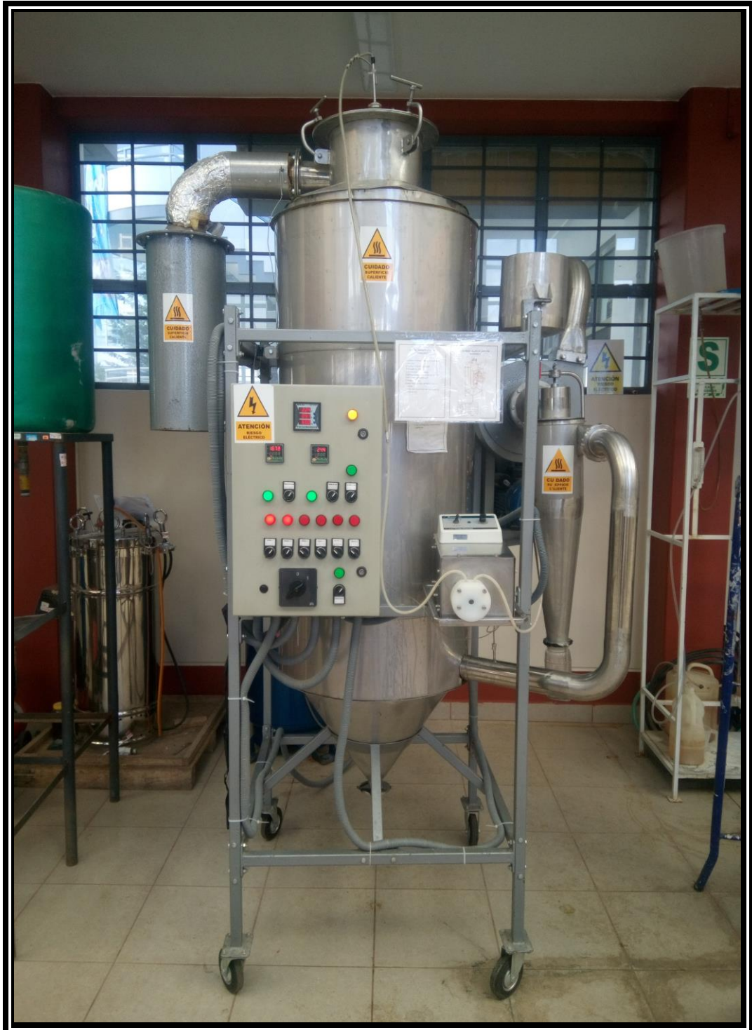
Figura C.1: Acondicionamiento del equipo de secado por atomización del laboratorio de operaciones y procesos unitarios de la facultad de Ingeniería Química de la UNA – PUNO.
