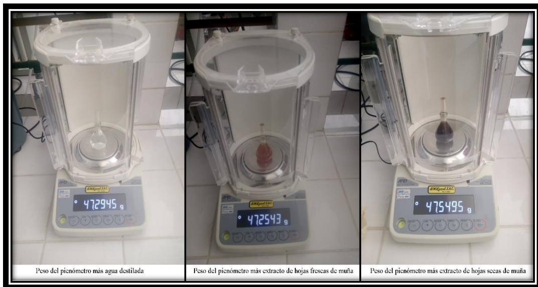
Figura C.8: Extractos pesados en picnómetro para la determinación de sus densidades utilizando una balanza analítica de marca H.W.K. Kessel, modelo HR- 25A.
