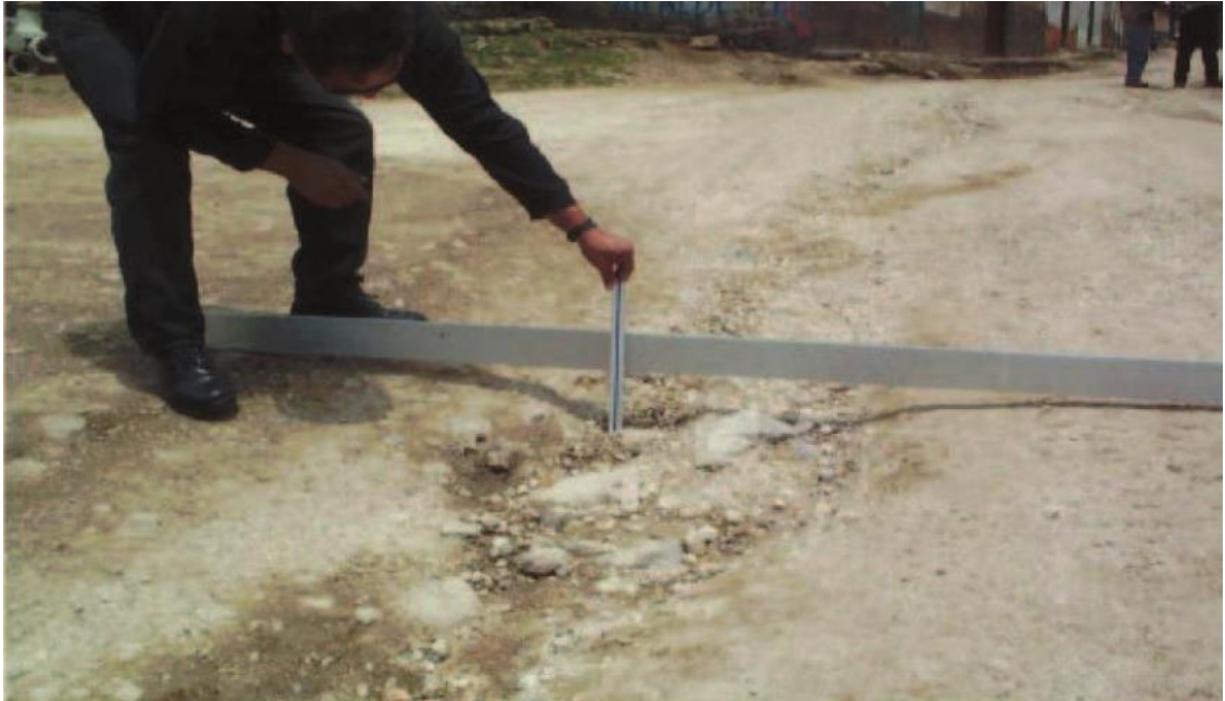
Figura 10: Gravedad 3: Profundidad \geq 10 cm.
