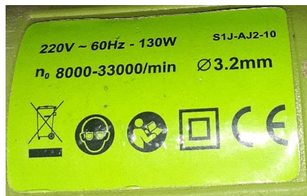
Figura N° 23: Características de mini torno motor taladro TOOLTECH.
