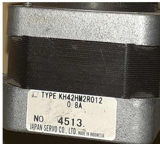
Figura N° 37: Motor paso a paso para el eje Z.
