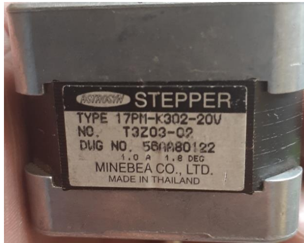
Figura N° 35: Motor paso a paso para el eje X.
