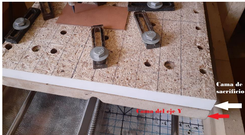
Figura N° 45: Diferencia entre tabla de sacrificio y bancada del eje Y.
