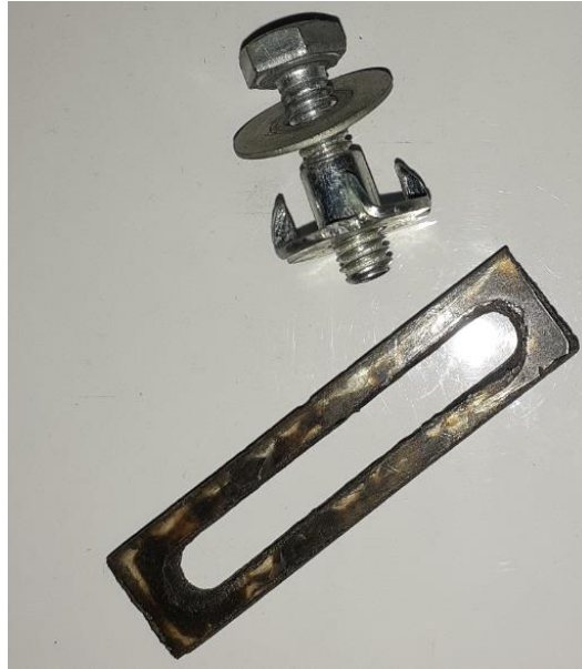
Figura N° 43: Perno de 1”, arandela, tuerca de inserto y clamps.
