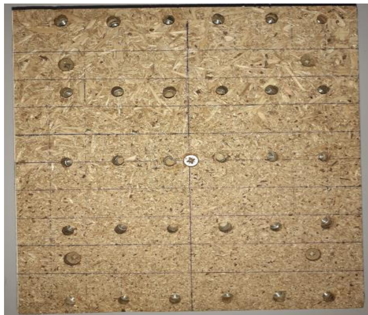
Figura N° 44: Tabla de sacrificio con tuercas de inserto instaladas.
