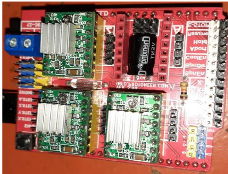
Figura N° 59: Shield CNC y controladores A4988 instalados.
