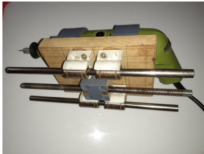
Figura N° 47: Instalación de soportes de sujeción para el eje Z.
