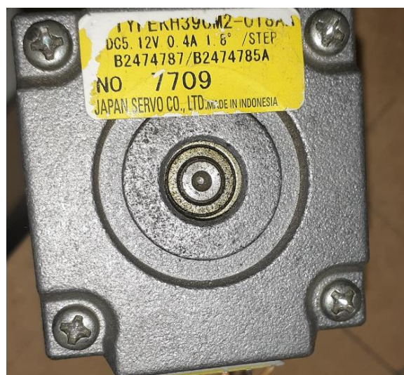
Figura N° 36: Motor paso a paso para el eje Y.
