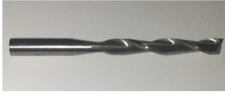
Figura N° 71: Broca de punta plana de 3mm.
