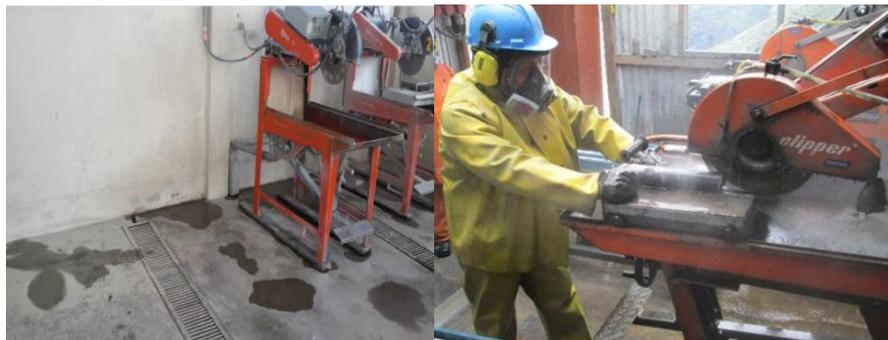
*Figura 33. Corte y rotulado de muestras de testigo.*
