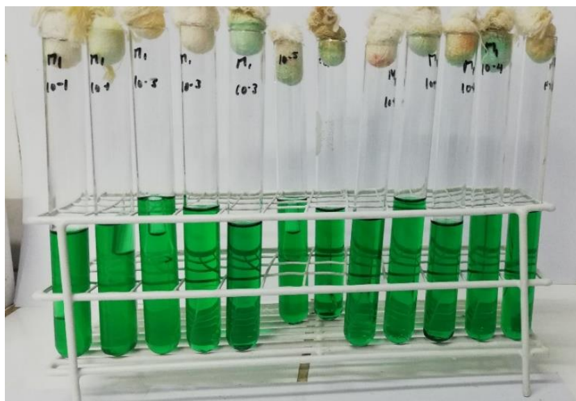
Figura 14. Tubos con caldo bilis lactosa verde brillante (BLVB) para la prueba confirmativa de coliformes termotolerantes, realizado en el laboratorio de Botánica y Biotecnología la FCCBB. UNA-Puno, Octubre 2019.
