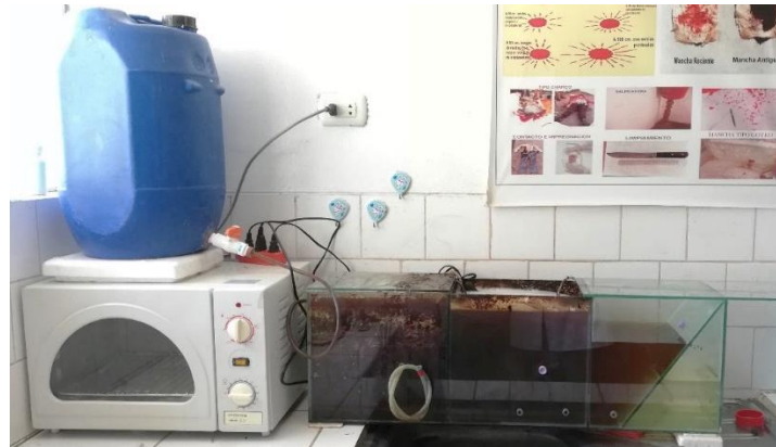
Figura 10. Reactor de lodos activados, acondicionado en el laboratorio de Biotecnología de la FCCBB. UNA- Puno, Noviembre 2019.
