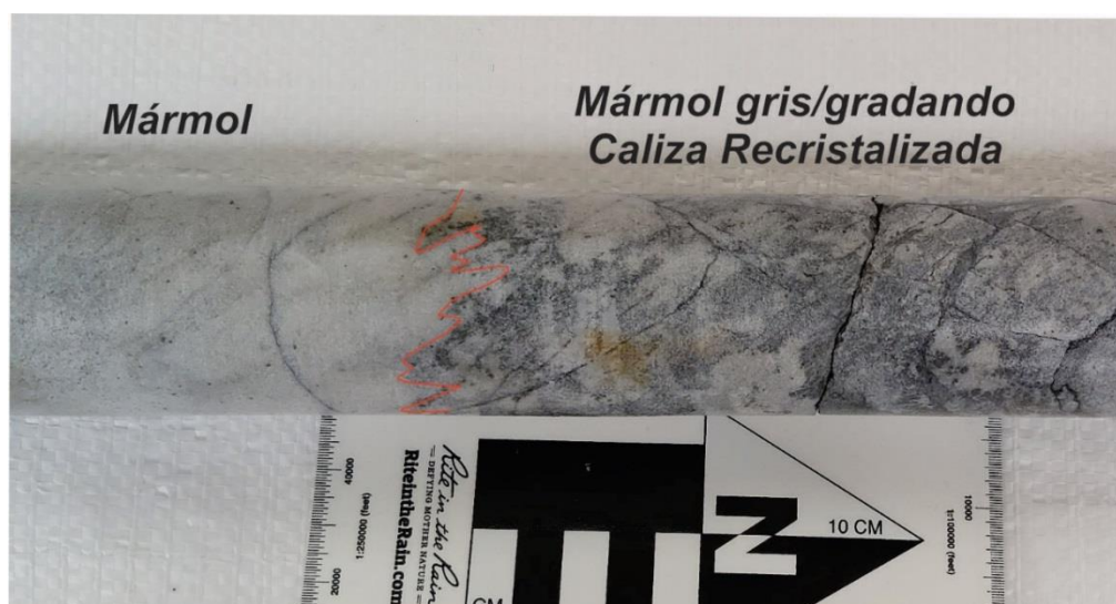
Figura N° 5. 2. Se observa una muestra de caliza recristalizada en contacto con el mármol blanquecina. Muestra de un testigo de perforación diamantina en línea NQ.
