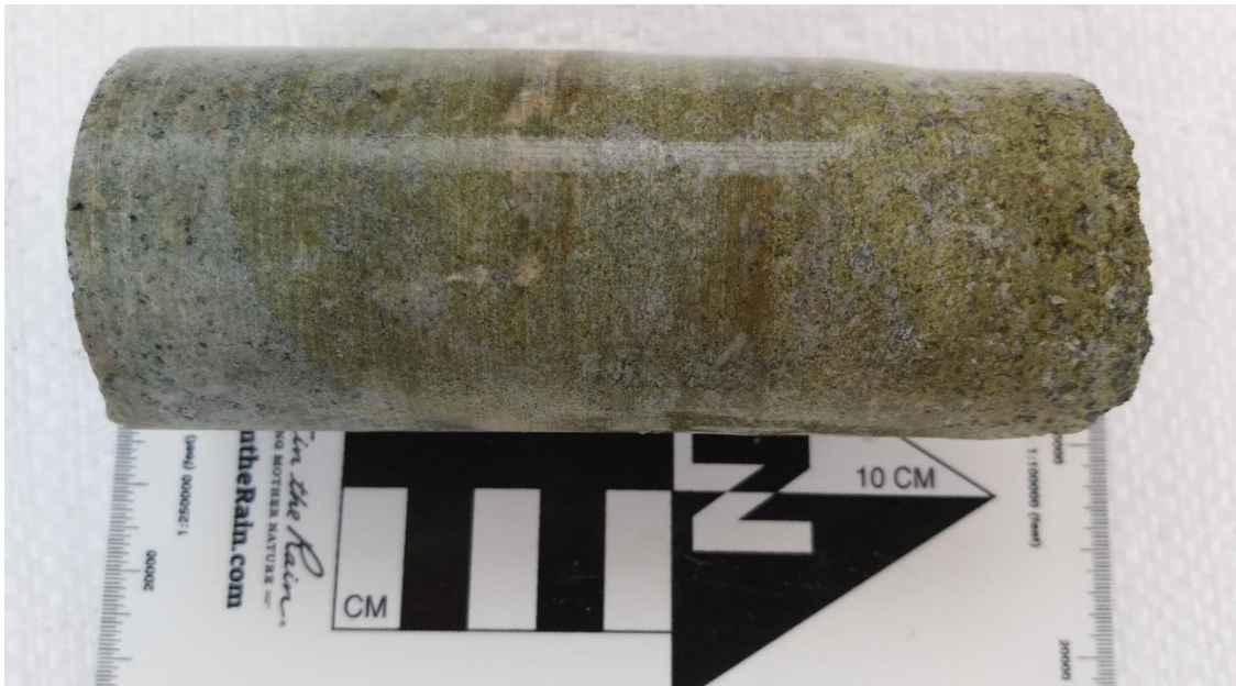
Figura N° 5. 5. Skarn con granates verdes ( grosularia ) y andraditas , wollastonita y pirita diseminada. Muestra de perforación diamantina línea NQ.
