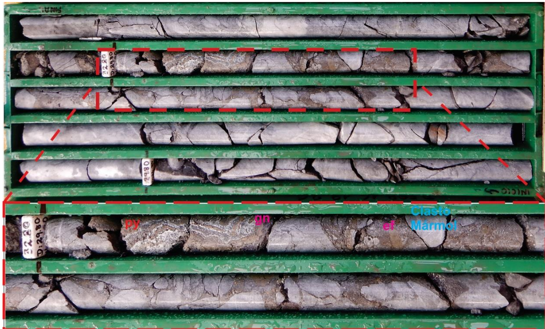
Figura N° 5. 4. Brecha tectónica mineralizado de pirita, galena, esfalerita y calcopirita en línea NQ de perforación diamantina.
