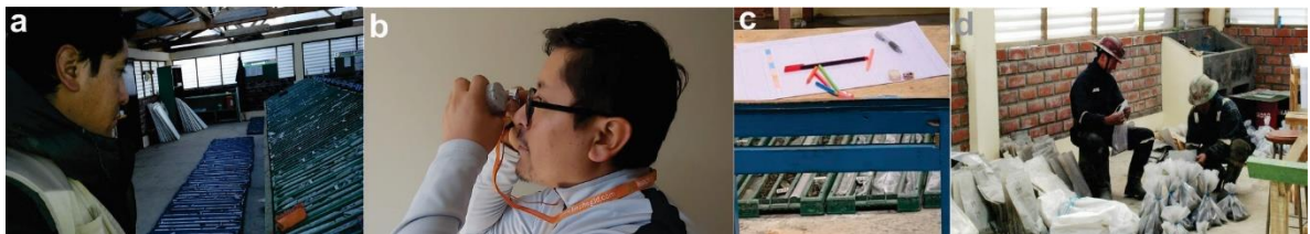
Figura N° 3. 3. Etapa de logueo y muestreo (a) cajas de muestra extendida, (b) geólogo realizando el logueo, (c) hojas de logueo detalladas, (d) etiquetado y embalado de muestras.
