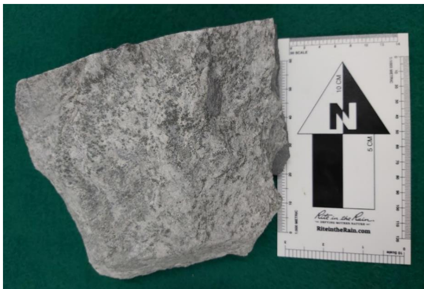
Figura N° 5. 3. Muestra de mármol color blanquecino, grano medio a grueso con diseminación de pirita en el flanco occidental del sinclinal de Yauricocha.
