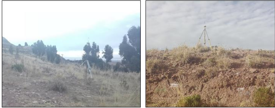
Figura N° 33: Estacionamiento GPS diferencial en los puntos de control PC1, PC2.
