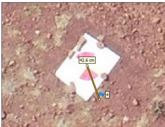
Figura N° 42: Desplazamiento de 42.6 cm en el punto de análisis 4.
