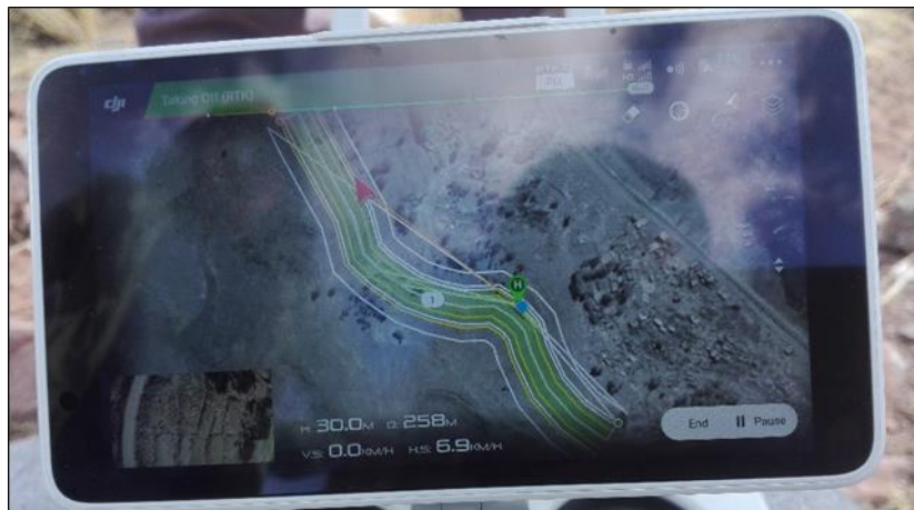
Figura N° 54: Vuelo programado a 30 metros de altura.
