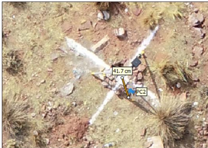
Figura N° 41: Desplazamiento de 41.7 cm en el punto de control PC2.
