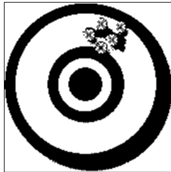
Figura N° 14: Precisión, uniformidad en los puntos pero inexacta.
