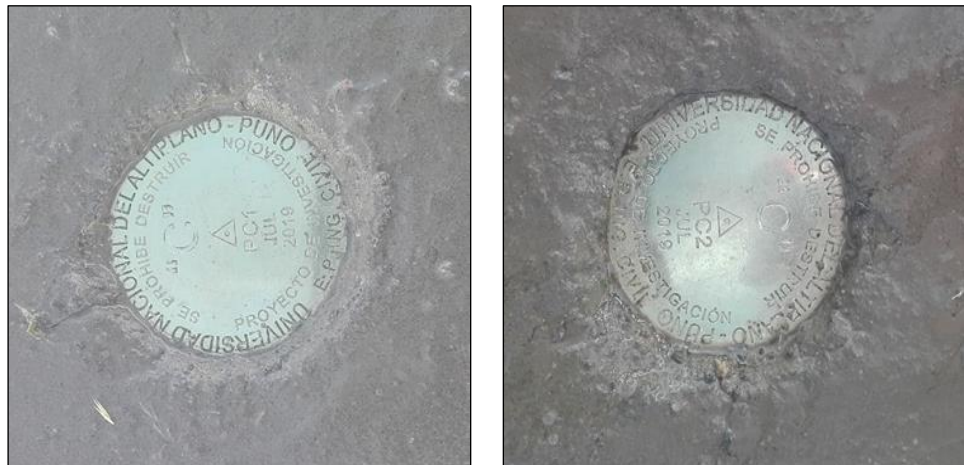
Figura N° 32: Monumentación de Puntos de control PCI, PC2.
