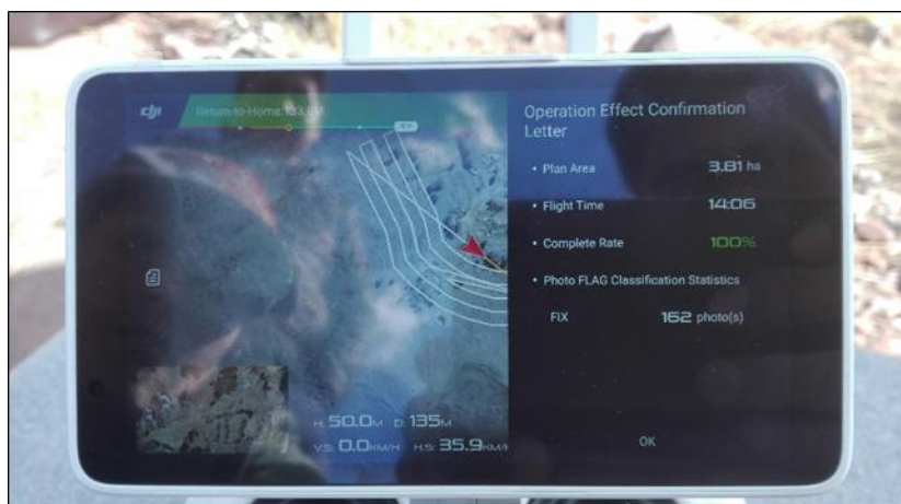
Figura N° 55: Vuelo programado a 50 metros de altura.
