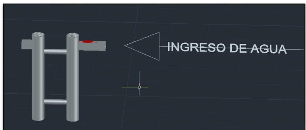
Figura 34: Posición del reed switch o interruptor de lengüeta
