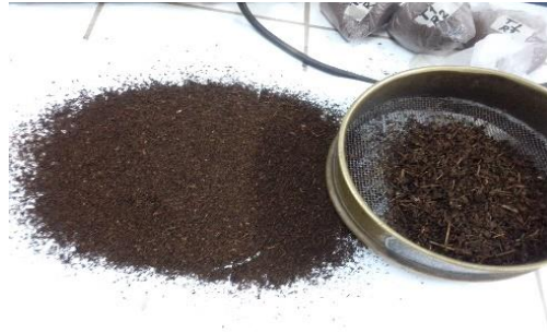
Figura 5. Tamizado de las muestras de compost a un diámetro menor de 1.5 mm, en el laboratorio de la Facultad de Ciencias Agrarias.
