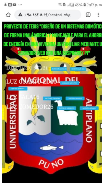
Figura N° 30: Página web de la instalación domótica en un Smart phone.
