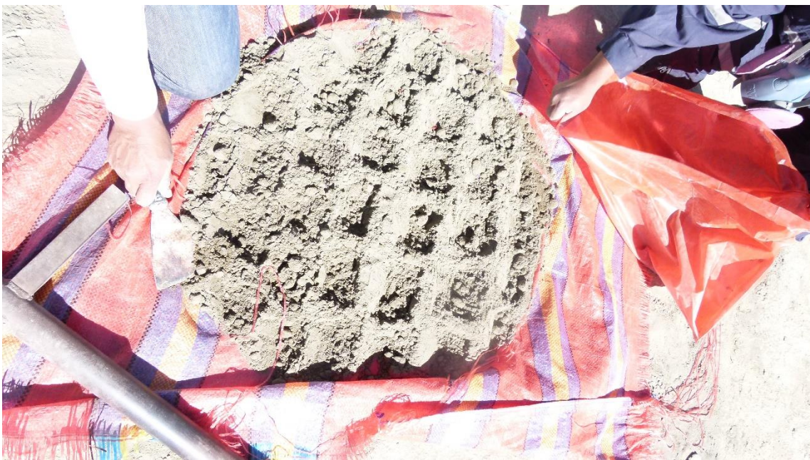
Figura N° 18. Método de muestreo sistemático alternado.
