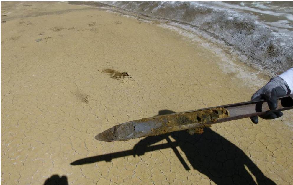
Figura N° 15. Muestra por corte (Muestreador tubular).
