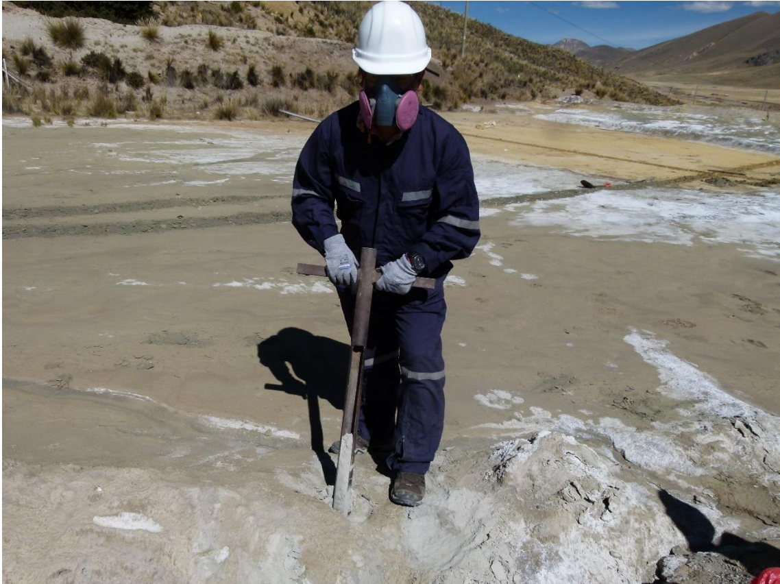
Figura N° 13. Uso del muestreador tubular
