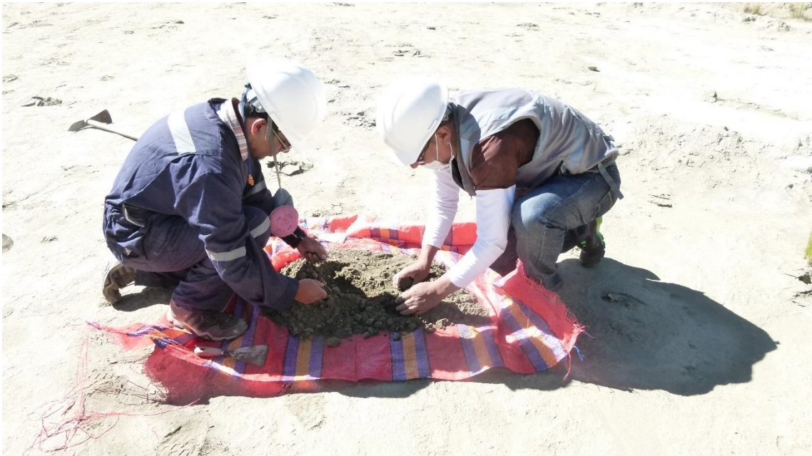
Figura N° 16. Homogenización de la muestra.
