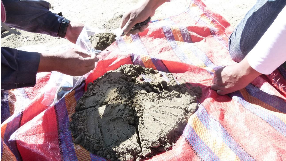
Figura N° 17. Método de cuarteo.
