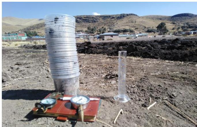
**Figura 15.** Equipo y materiales para el calculo de la eficiaencia de aplicacion de riego
