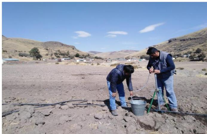
**Figura 16.** Aforacion de un aspensor de una linea de riego
