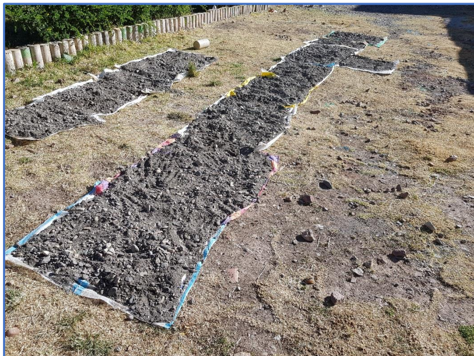
Figura A. 6 Secado al sol del agregado global (Exteriores del laboratorio Construcciones UNA).
