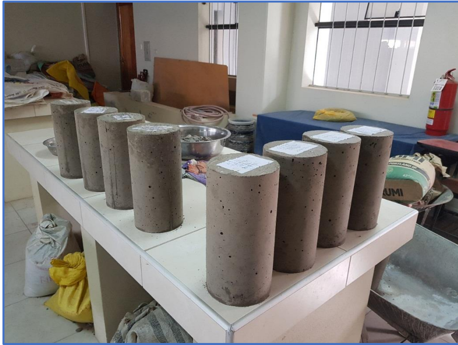
Figura A. 16 Probetas de concreto desmoldadas (24 horas después) en estado endurecido. Laboratorio de Construcciones UNA
