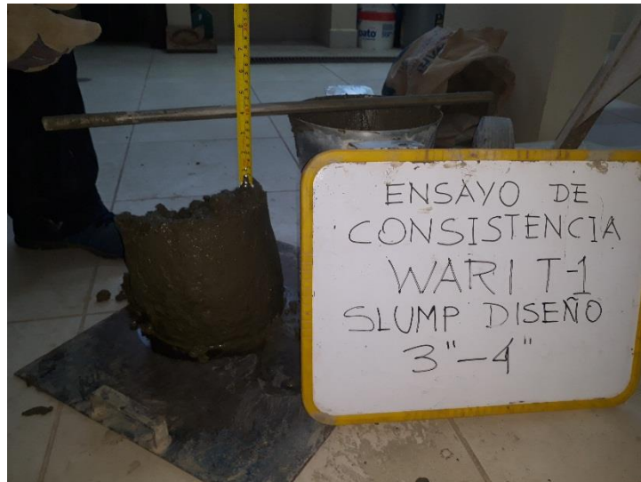
Figura 13. Ensayo de consistencia (cono de abrams). Fuente: Elaborado por el equipo de trabajo
