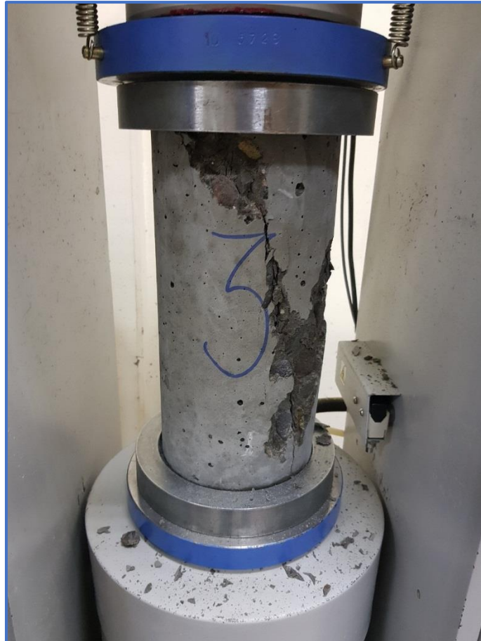
Figura A. 20 Probeta de concreto ensayada, se aprecia la falla tipo 4 (NTP 339.034) Laboratorio de Construcciones UNA
