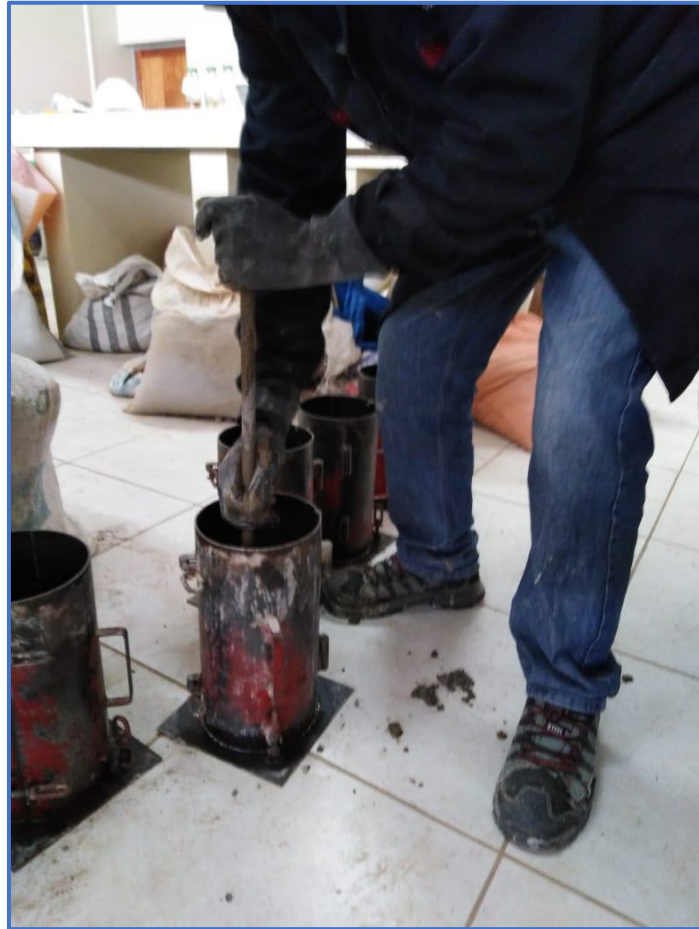
Figura A. 13 Vaciado y apisonado de las probetas de concreto fresco (NTP 339.033) Laboratorio de Construcciones UNA.
