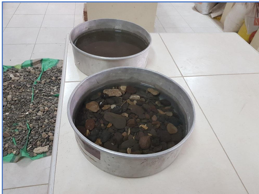
Figura A. 8 Saturación del Agregado Fino y Grueso para ensayo de P.E. y Absorción (NTP 400.021 y 400.022)
