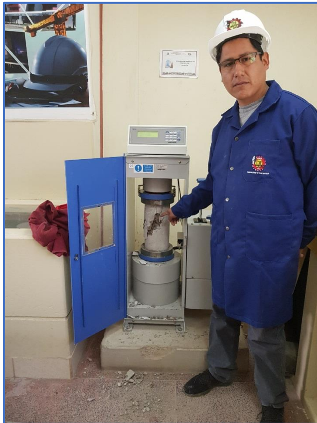
Figura A. 18. Ensayo de compresión simple (Equipo Ele International) Laboratorio de Construcciones UNA.
