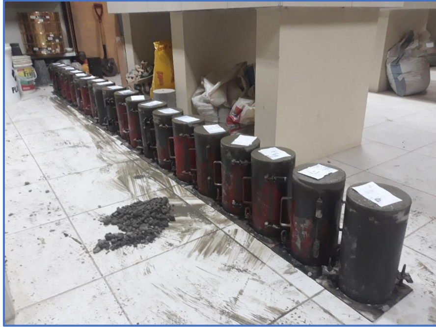
Figura A. 14 Probetas con concreto en estado fresco (terminadas) Laboratorio de Construcciones UNA.
