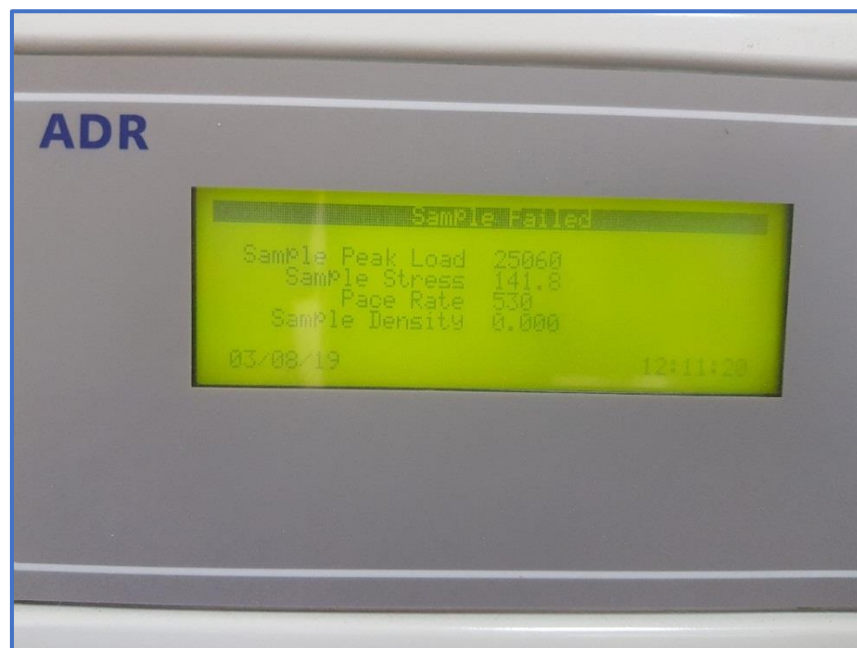
Figura A. 19 Resultados del ensayo a compresión (Equipo Ele International) Laboratorio de Construcciones UNA.
