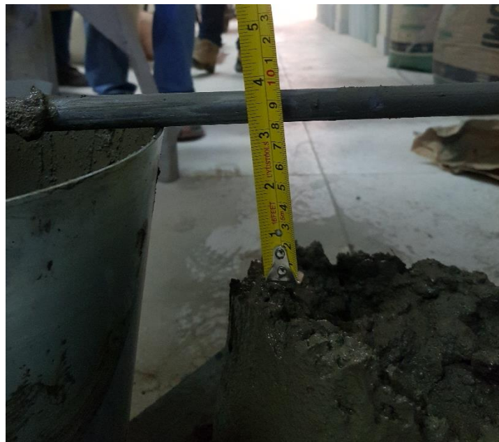
Figura 14. Medición del asentamiento mediante el ensayo de consistencia (cono de abrams). Fuente: Elaborado por el equipo de trabajo
