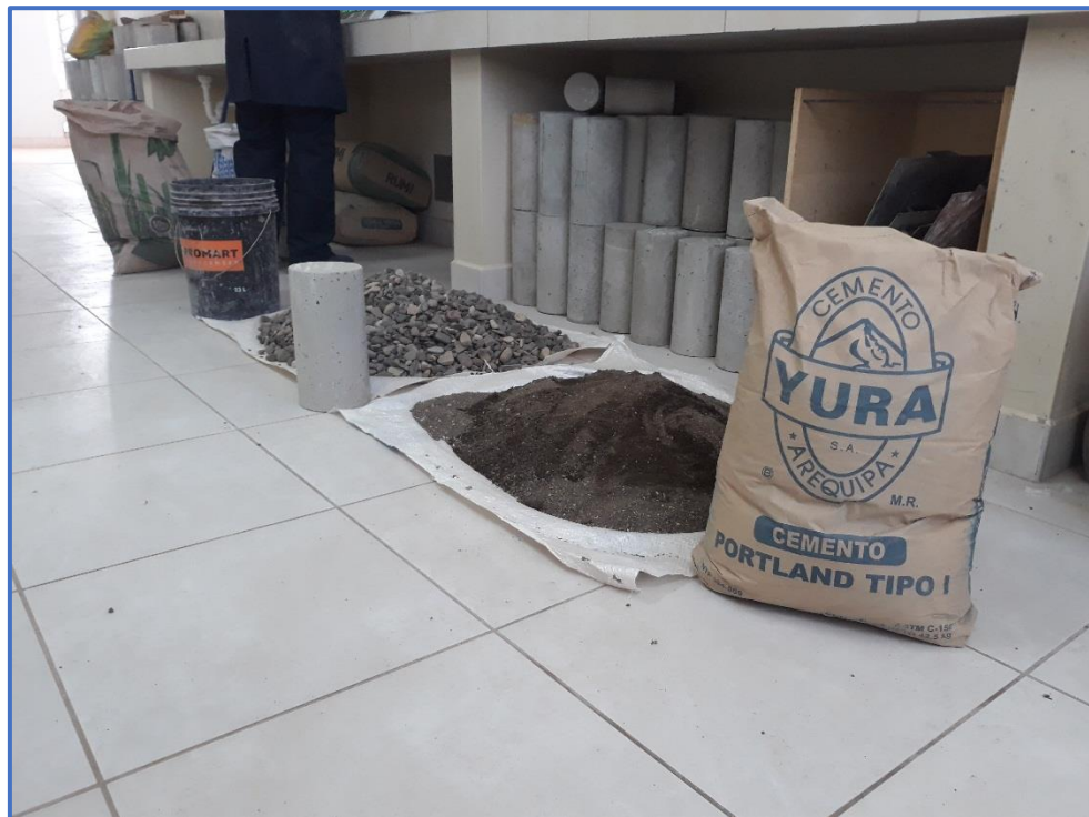
Figura A. 10 Dosificación en peso de los materiales de acuerdo al diseño de mezclas WALKER, con cemento Yura tipo I.
