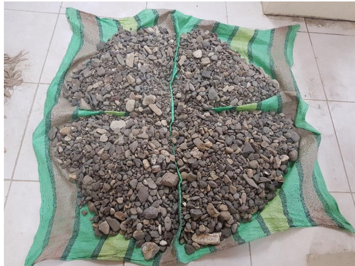
Figura 9. Agregado grueso de la cantera Viluyo.
