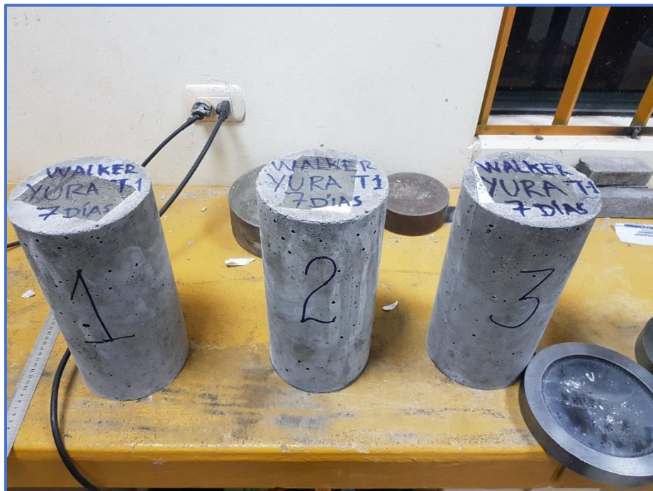
Figura A. 17 Probetas de concreto para ensayo de compresión a los 7 días de edad Laboratorio de Construcciones UNA.
