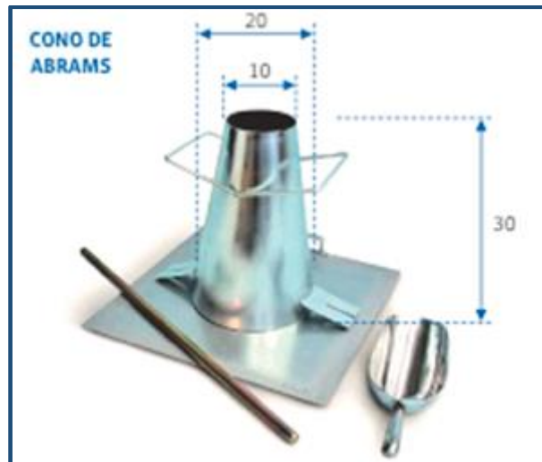
Figura 4. Equipo Cono de Abrams, para el ensayo de consistencia del concreto
