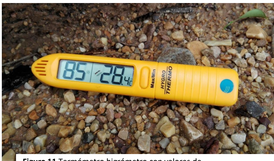
Figura 11 Termómetro higrómetro con valores de temperatura y humedad relativa ambiental en la época menos lluviosa.
