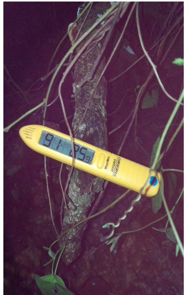
Figura 10 Termómetro higrómetro con valores de temperatura y humedad relativa ambiental en la época más lluviosa.
