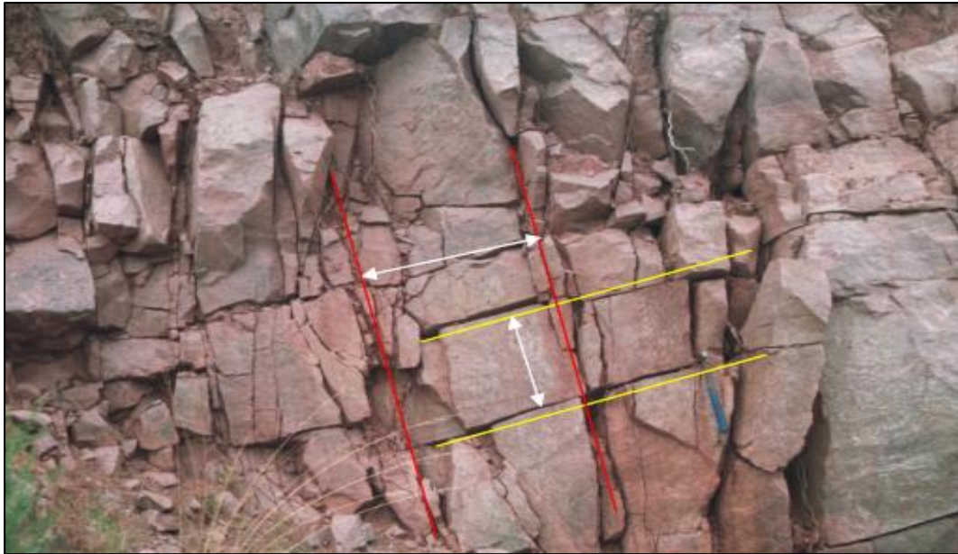
Figura 2.7. Espaciado entre discontinuidades.
