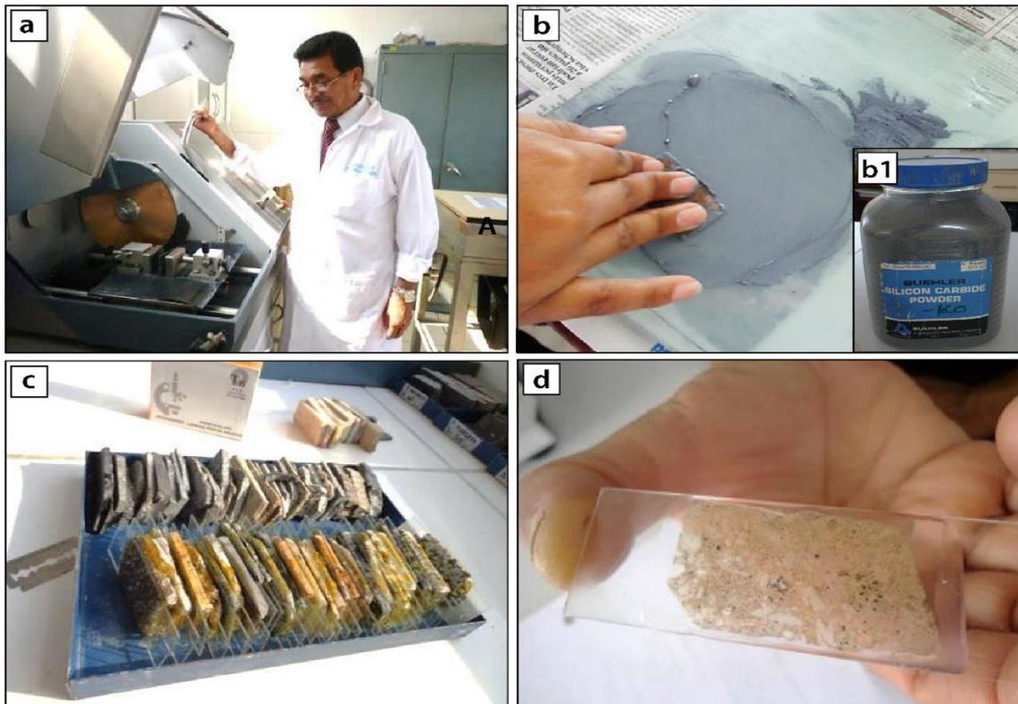
**Figura 9.** a) Se aprecia cortadora automática, donde se realizó el corte inicial obteniendo un chip o galleta de 2x1x1 cm; b) desbaste de la galleta o chip con el Carburo de Silíceo Nro. 120, 400 y 600 (b1); c) galleta o chip impregnados y con porta objetos; y d) sección delgada a 30 micras. Fuente: INGEMMET–DGR–GR39B: Inédita de esta tesis.
