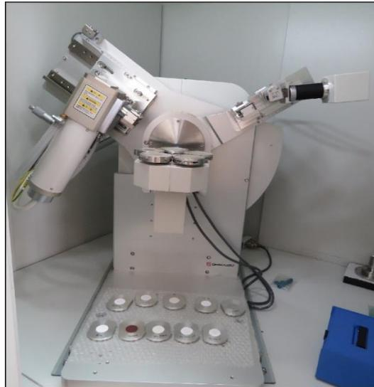
**Figura 13.** Difractometro de rayos X SHIMADZU, modelo XRD-600. Fuente: INGEMMET–DGR–GR39B: Inédita de esta tesis.
