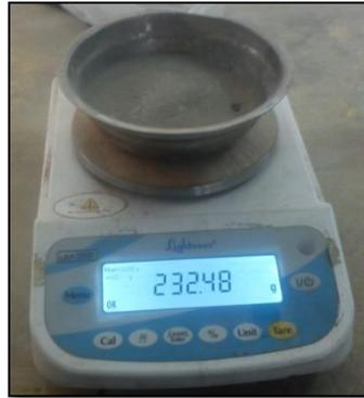
Figura 3-27 Muestra despues de tamizado por la malla N40
