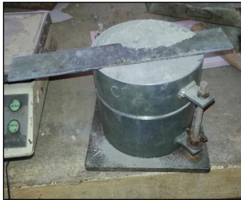
Figura 3-53 Enrase de la muestra en el molde cilíndrico
