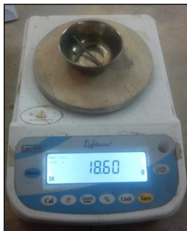
Figura 3-33 Contenido de humedad en el límite plástico
