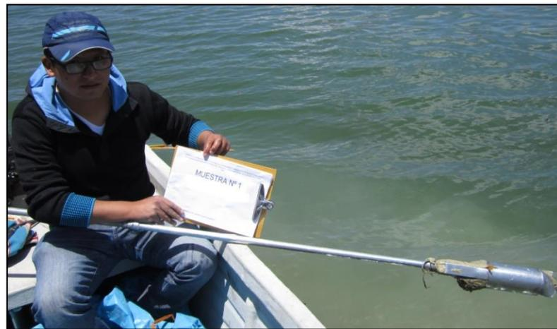
Figura 3-14 Toma de muestras de turba con el barreno tipo Posteadora
