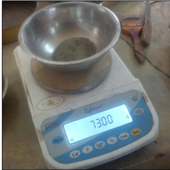
Figura 3-41 Muestra aproximada para el picnometro de 250 cm<sup>3</sup>
