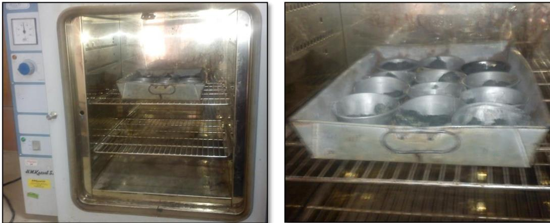
Figura 3-23 Muestra llevada a horno y enfriada unos 15 minutos antes de pesar
