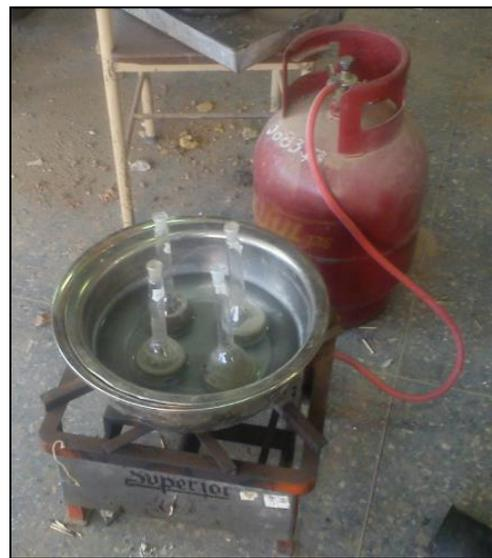
Figura 3-42 Muestra húmeda en el picnometro y baño María
