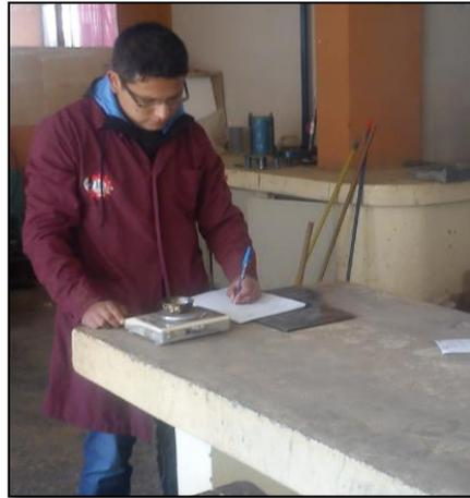
Figura 3-29 Contenido de humedad en el límite líquido
