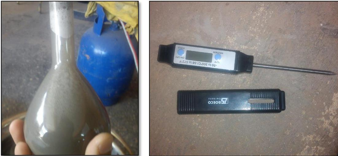
Figura 3-43 Eliminación del aire atrapado y corrección con el termómetro
