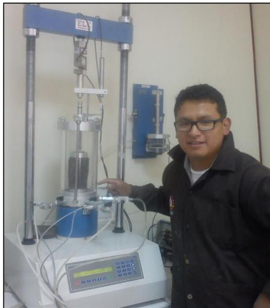
Figura 3-47 Ensayo de compresión simple en el equipo triaxial
