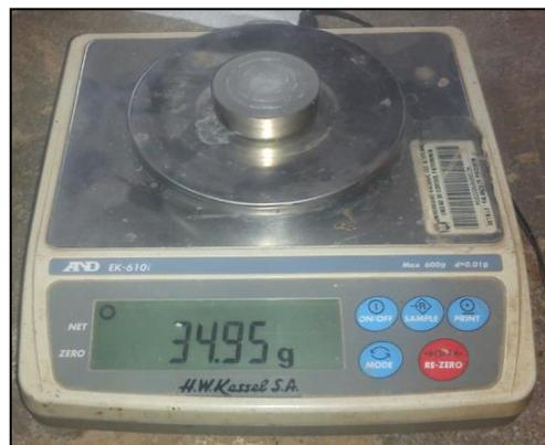
Figura 3-39 Determinacion de la densidad de la parafina en laboratorio
