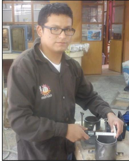
Figura 3-50 Verificación de la dimensiones del molde (MTC E 203-2000)
