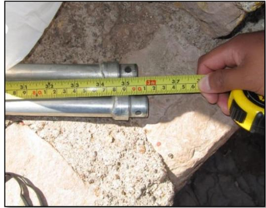
Figura 3-11 Armado del barreno tipo postadora y medición de su longitud.
