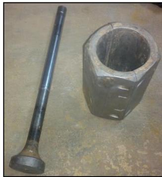
Figura 3-44 Molde para el ensayo de compresión
