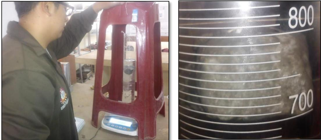
Figura 3-38 Muestra sumergida sin tocar las paredes del cilindro de vidrio
