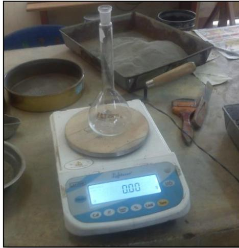
Figura 3-40 Peso y volumen (250 ml) del picnómetro
