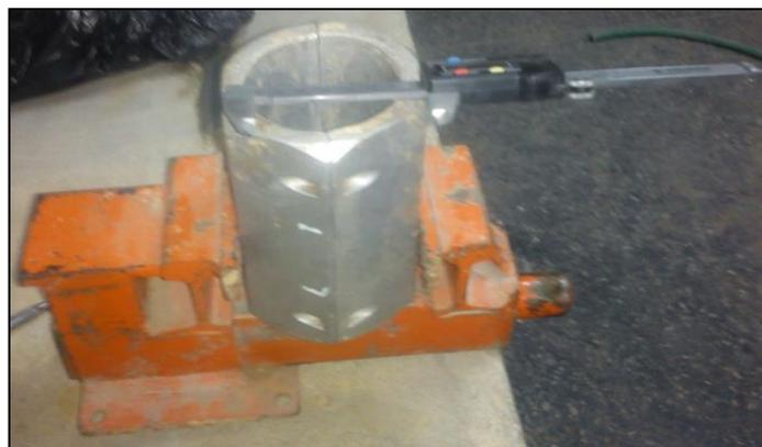
Figura 3-45 Obtención del volumen del molde
