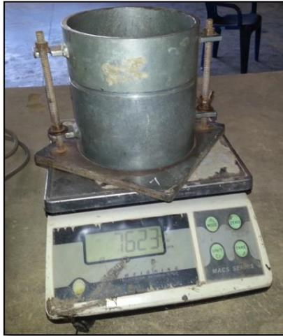
Figura 3-52 Peso del molde cilíndrico vacío
