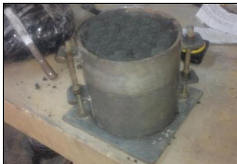
Figura 3-54 Peso de la muestra más el molde cilíndrico como mínimo 3 veces
