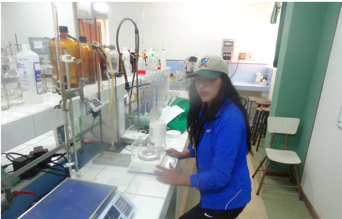
Figura 30. Pesado en (g) del enraizante AIB vertidos en una probeta de 100 ml de solución, 09 de octubre del 2018.
