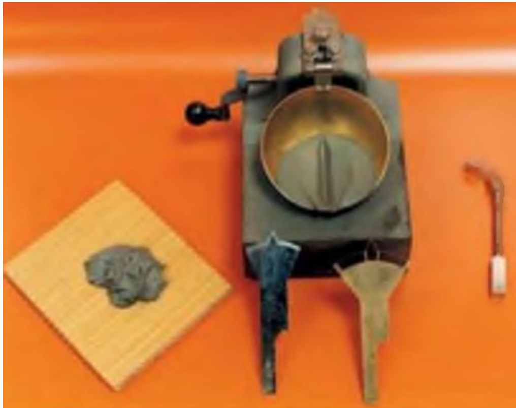
Figura 24. Cuchara de Casagrande para determinación del límite líquido. Fuente: (González de vallejo, Ferrer, Ortuño, & Oteo, 2002)
