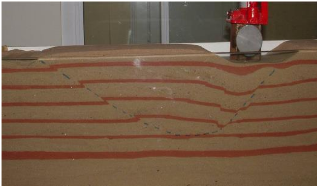
Figura 5. Falla de una base apoyada sobre un manto de arena en un ensayo en modelo realizado en el laboratorio de mecánica de suelos
