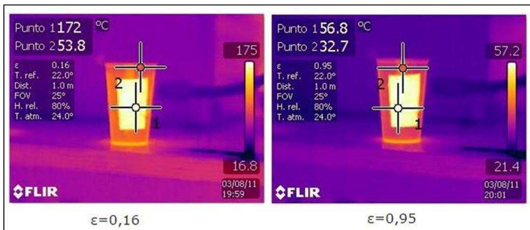
Figura N°2.15: Medición de Temperatura con una Emisividad.
