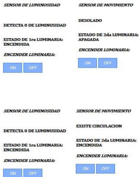
Figura N° 48: Resultado en el navegador web cuando solamente se detecta movimiento el segundo alumbrado.
