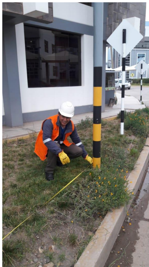
Figura N° 56: Medición de la distancia entre dos postes. Elaboración propia.
