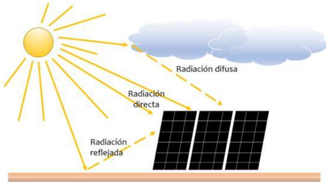
Figura 12: Componentes de la radiación solar.
